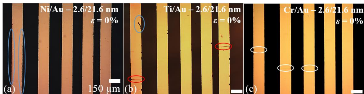
Figure II-6. Effets de différents types de métaux sur les fissures de procédé en films couches minces sur PDMS sans déformation appliquée. (a) Lignes de nickel/or (2,6/21,6 nm). (b) Lignes de titane/or (2,6/21,6 nm). (c) Lignes de chrome/or (2,6/21,6 nm). Les barres d'échelles représentent 150 μm.
