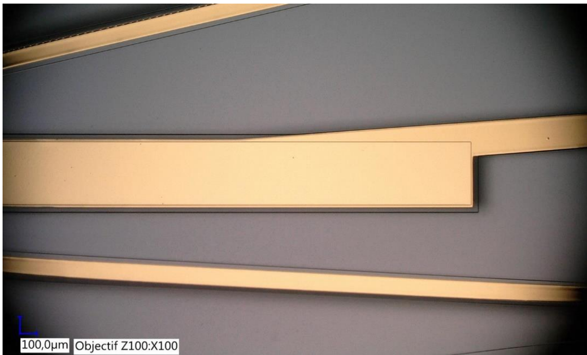
Figure V-8. Photographie de l'électrode de référence avant gravure au plasma oxygène. L'électrode de référence mesure 3800 μm de longueur par 400 μm de largeur.
