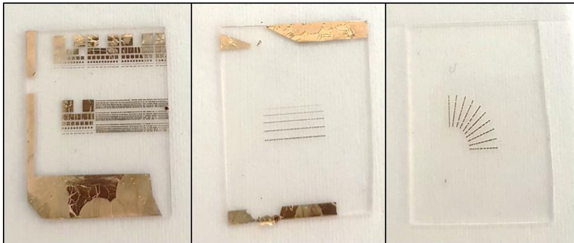
Figure III-4. Photographies des trois échantillons de PDMS réalisés grâce aux trois masques physiques différents. Les motifs sont réalisés à partir d'une couche d'accroche de titane d'une épaisseur de 5 nm recouverte d'une épaisseur de 50 nm d'or.
