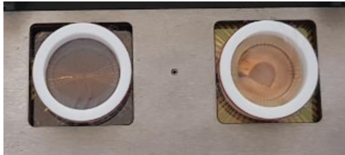
Figure V-12. MEA 2100© contenant un microsystème réalisé en PDMS à gauche et un MEA commercial à droite.
