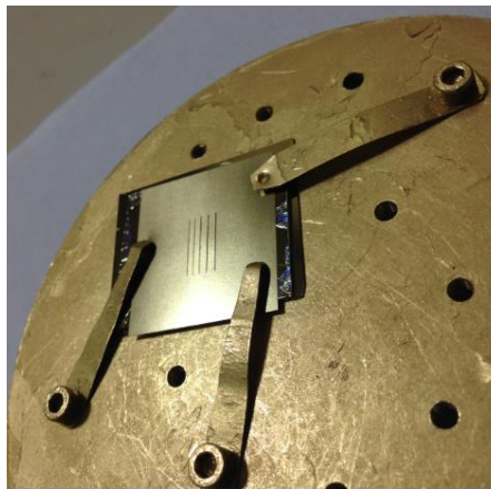
Figure II-3. Echantillon de PDMS surmonté par un masque physique, le tout maintenu par des pinces sur un porte échantillon.
