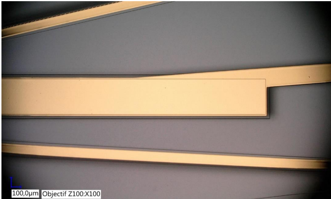
Figure V-8. Photographie de l'électrode de référence avant gravure au plasma oxygène. L'électrode de référence mesure 3800 \mu\text{m} de longueur par 400 \mu\text{m} de largeur.
