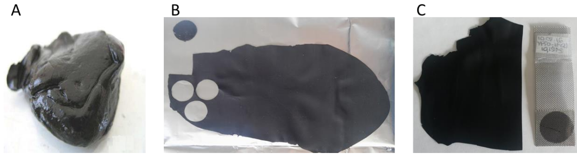
Figure II.2 Synthèse de MnO_2 . (A) mélange de poudre de MnO_2 avec du carbone conducteur et un liant ;(B) pâte composite étalée et séché puis découpé à l'emporte-pièce pour former l'électrode et (C) électrode pressée sur une grille d'inox utilisée comme collecteur de courant
