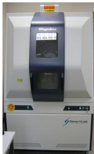
Figure II.21 Diffractomètre Rigaku Smartlab Utilisé durant cette thèse
