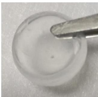
Figure VI.20 Ionogel de MMIm MPO<sub>3</sub> fait en utilisant du TMOS (LI/TMOS=0,5) et de l'AF (AF/TMOS=7)
