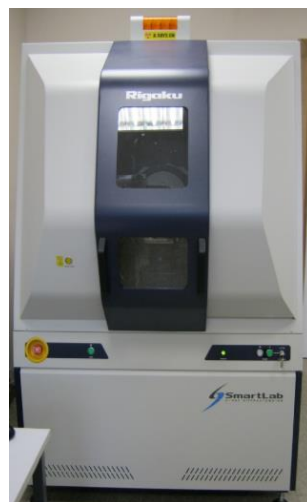
Figure II.21 Diffractomètre Rigaku Smartlab Utilisé durant cette thèse
