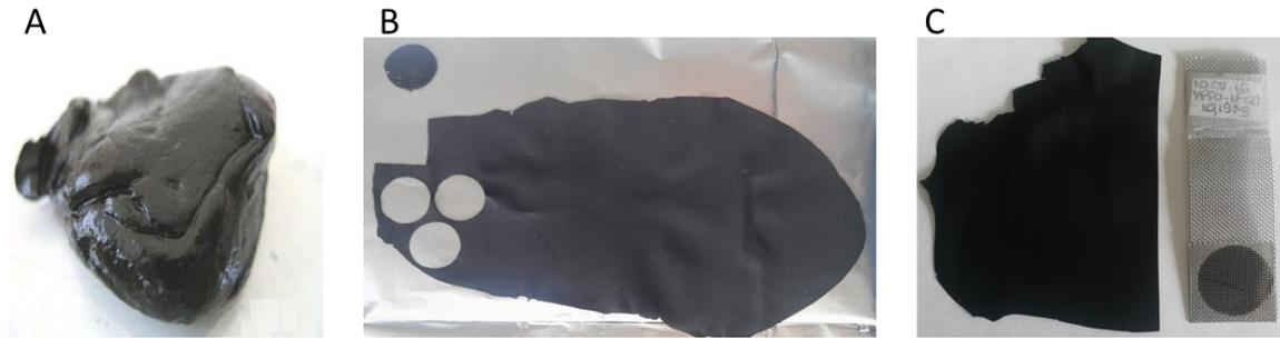
Figure II.2 Synthèse de  $MnO_2$ . (A) mélange de poudre de  $MnO_2$  avec du carbone conducteur et un liant ;(B) pâte composite étalée et séché puis découpé à l'emporte-pièce pour former l'électrode et (C) électrode pressée sur une grille d'inox utilisée comme collecteur de courant
