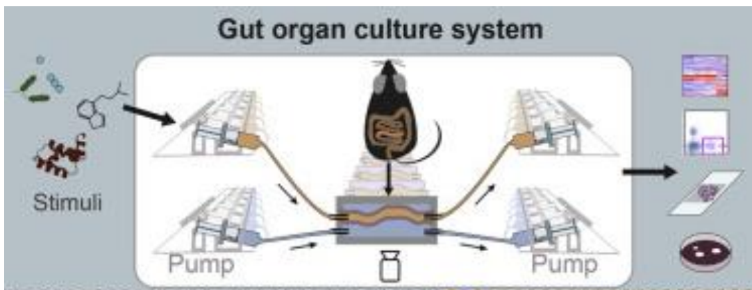
Figure V-7 Schéma d'ensemble du système de culture d'intestin de souris. 6 chambres de culture reliées chacune à deux pompes dont une est pour la distribution du milieu de culture et l'autre est utilisée pour la distribution des stimuli extérieurs. L'ensemble du dispositif est associé à un système d'imagerie permettant une observation en temps réel (Yissachar et al. , 2017)
