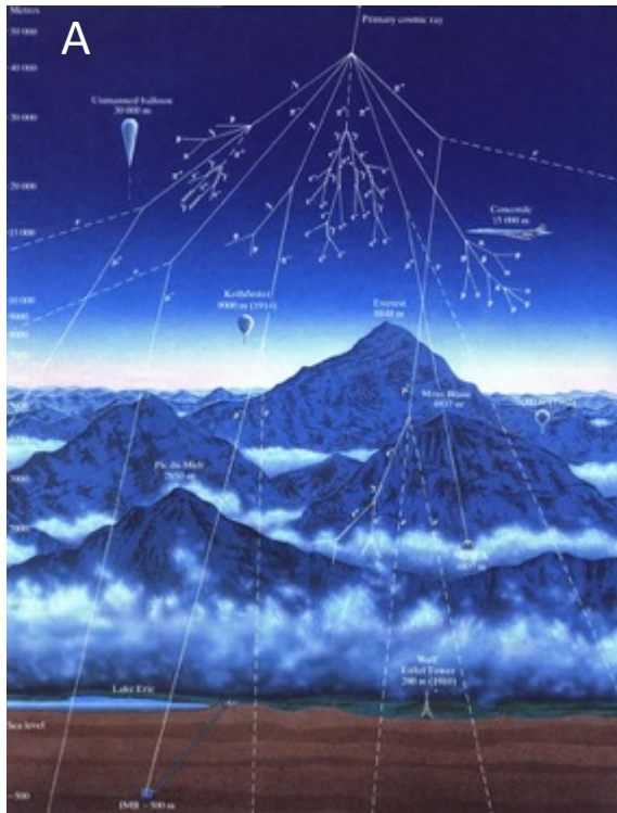
Figure 2.6 – A) Cascade atmosphérique des particules cosmiques primaires et secondaires (Chelkov : http://uc.jinr.ru/images/pdf/projects/shelkov.pdf ) B) Spectre énergétique des neutrons cosmiques secondaires au niveau de la mer (Dunai, 2010, données de Goldhagen et al., 2002).
