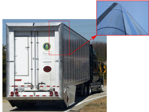
FIGURE 1.5 – Images de la configuration expérimentale de Englar (2005) avec une remorque de camion complète équipée de surfaces passives arrondies et un zoom avec la vectorisation de l'air visible par les brins de laine restant collés aux surfaces par effet Coanda.
