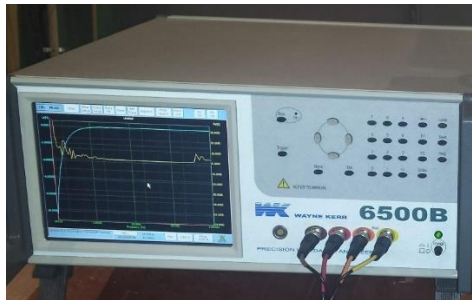
Fig. 5.1. Precision impedance analyser Wayne Kerr 6500B
