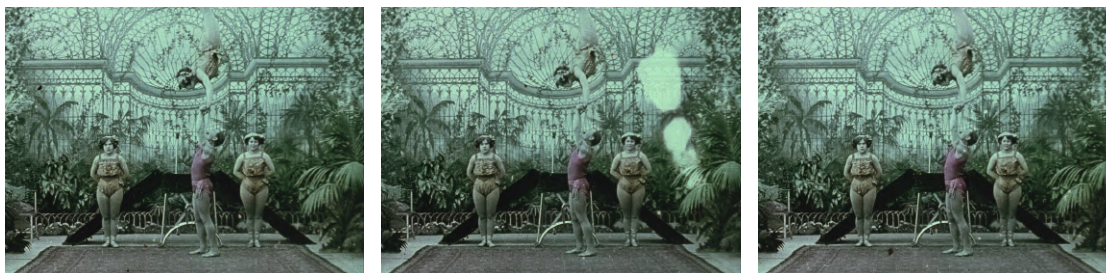
FIGURE 1.15 – Trois images successives comportant un défaut de type tache présent uniquement dans l'image centrale.
