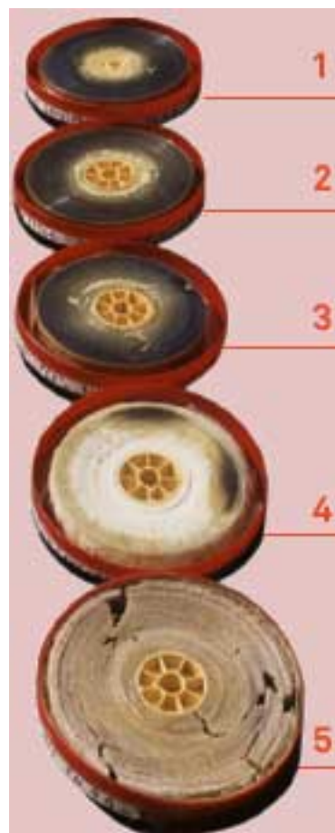
FIGURE 1.10 – Les différentes étapes de dégradation du nitrate de cellulose.
