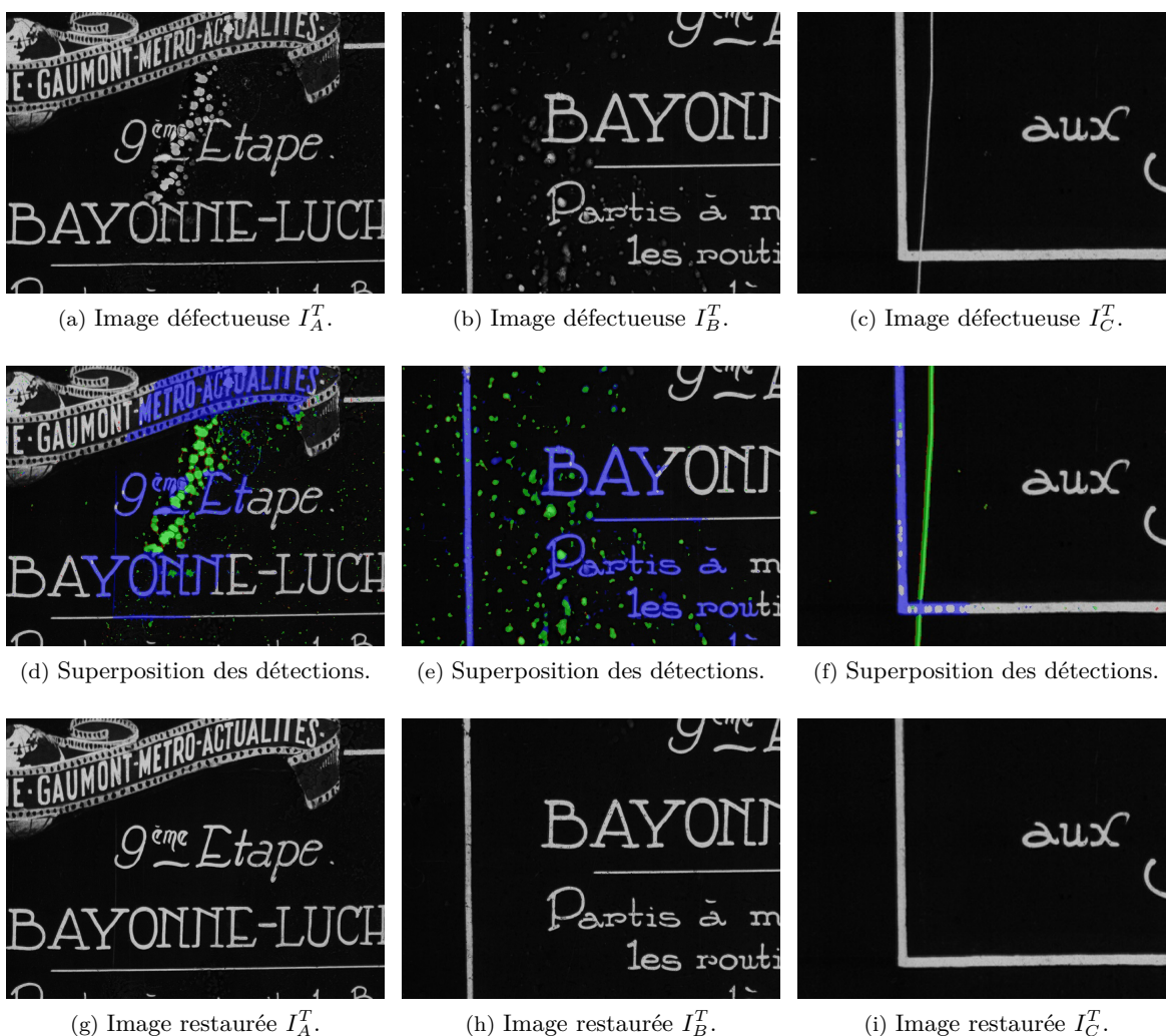
FIGURE 3.12 – Comparaison des différents masques dans des scènes de texte. Les vrais positifs sont indiqués en vert, les faux négatifs en bleu et les faux positifs en rouge. La sur-restauration entraîne l'apparition de larges parties bleues pour des zones considérées comme saines en comparant les images avant et après restauration.
