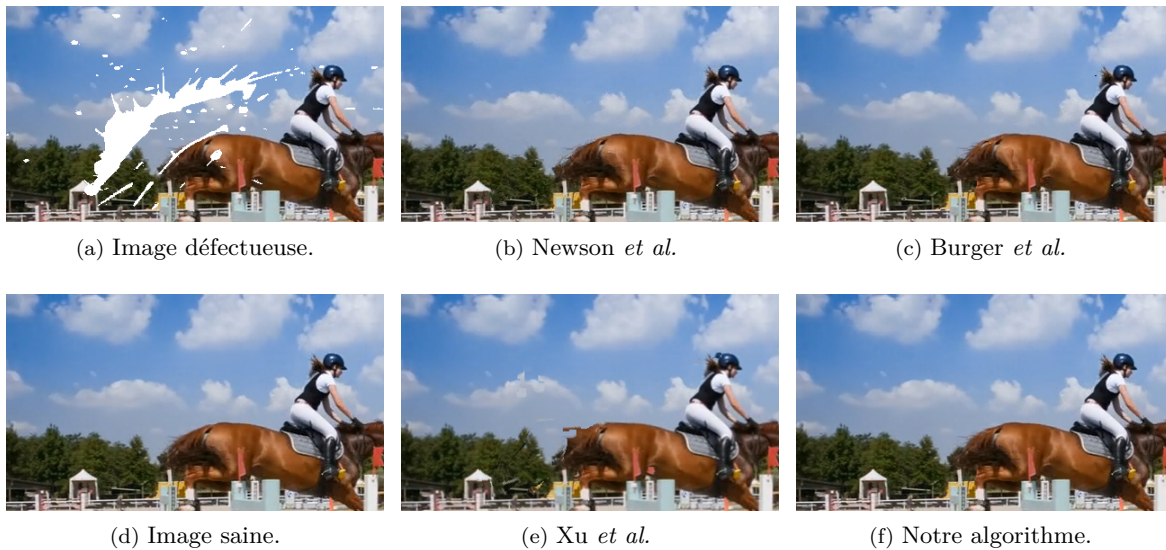
FIGURE 4.11 – Zoom sur la zone restaurée dans l'image 10 de la séquence « Horse ». Les méthodes qui ne reconstruisent pas la structure (4.11b et 4.11e) ne parviennent pas à restaurer correctement les arbres et les nuages. L'ajout de la texture dans notre algorithme (4.11f) permet une meilleure reconstruction de l'arrière-train du cheval par rapport à la seule reconstruction de la structure (4.11c).
