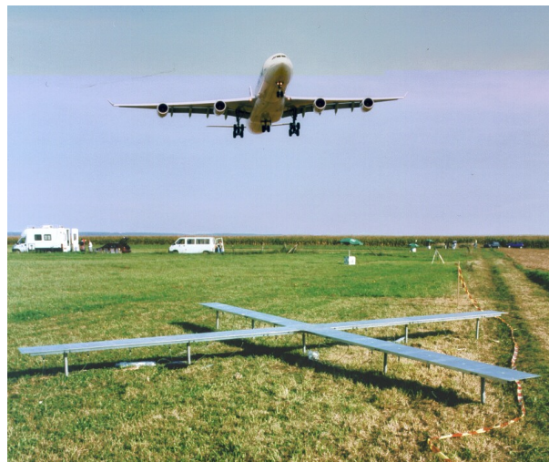
FIGURE I.8 – Illustration d'une campagne de mesure de bruit par survol d'un réseau microphonique
