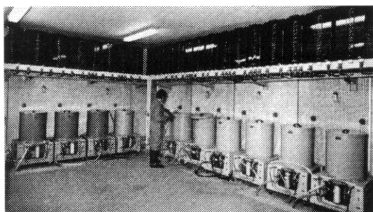
Développement du film (1) : bains des pellicules
