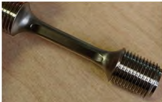
FIGURE D.1 – Géométrie des éprouvettes d'intrusion-extrusion.
