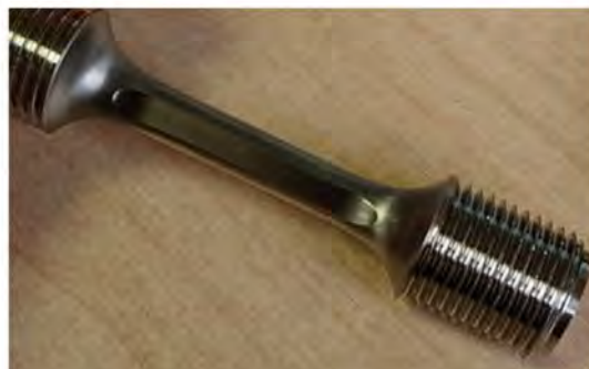
FIGURE D.1 – Géométrie des éprouvettes d'intrusion-extrusion.
