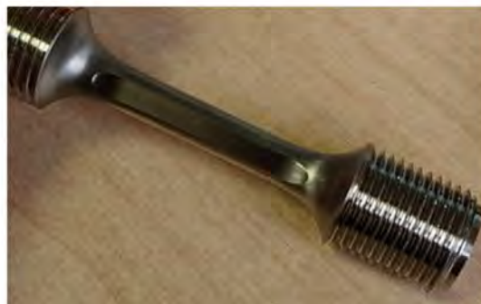
FIGURE D.1 – Géométrie des éprouvettes d'intrusion-extrusion.
