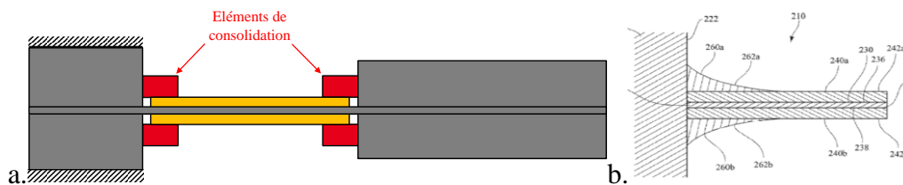
Figure IV.13 : Configuration avec éléments de consolidations : a. représentation, b. figure du brevet [175]
