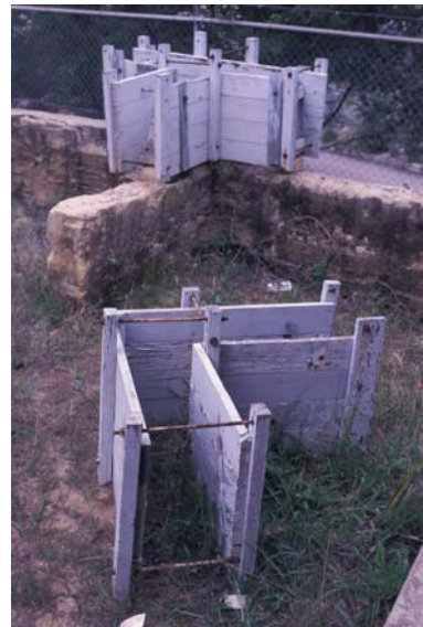
Fig. 3 : Coffrages spéciaux en forme de « L » et de « T », imaginés par G.F. Middleton, dans les années 1950, en Australie. Observés au National Building Technology Centre de Chastwood, Sydney, En 1988 (H. Guillaud).
