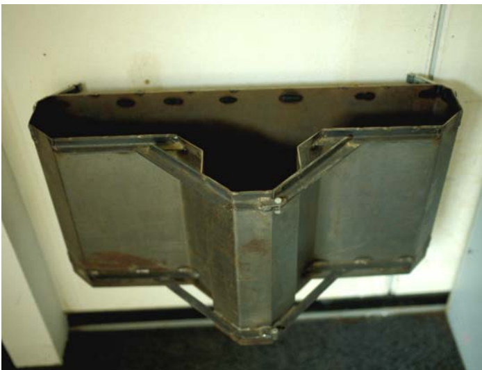
Fig. 18 : Coffrage spécial métallique en « T » pour réaliser des piliers/trumeaux auto stables. A été utilisé sur un chantier de construction parasismique au Guatemala, par l'ingénieur allemand Gernot Minke, en 1979 (H. Guillaud).
