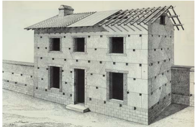
Fig. 1 b : Maison type en pisé de la région du Lyonnais (Rondelet, J.B. – Planche du Traité de l'Art de Bâtir, 1840, Livre 1 er , 1 ère Section, Chap. 2 Réédité en fac simile par l'Instituto Juan de Herrera, Fondo antiguo de la Escuela Superior de Arquitectura de Madrid, 216 p., p. 9.
