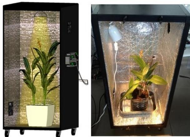
**Fig. 8.2.:** Enceinte climatique dédiée aux expérimentations
