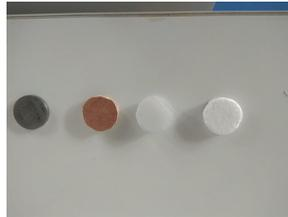
Fig. 6.6.: Échantillons testés (de la gauche vers la droite) : le fer, le bois, le polystyrène et le polycarbonate
