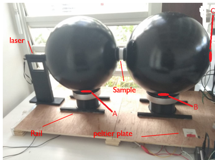
Fig. 6.4.: Positionnement des capteurs A, B et C sur le dispositif expérimental McM
