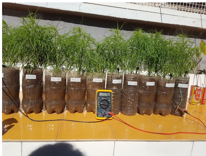
Fig. 8.8.: Mesure sur un montage en série de 10 pots de robinia
