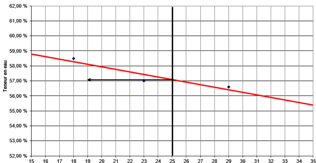
Graph 29: Courbe de la limite de liquidité de l'échantillon P 3
