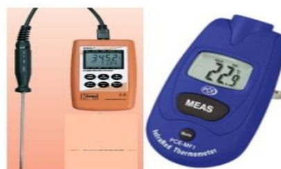
Photo 9 : Thermomètre de contact pour mesurer la température de la paroi
