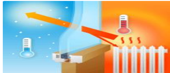
Figure 40 : coefficient de transmission thermique d'une baie vitrée
