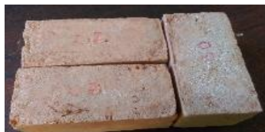
Photo 35 : Échantillon des briques artisanales en terre cuite d'Ambohitrimanjaka
