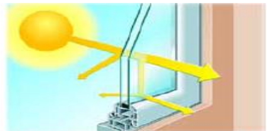
Figure 42 : Le facteur solaire d'une baie vitrée
