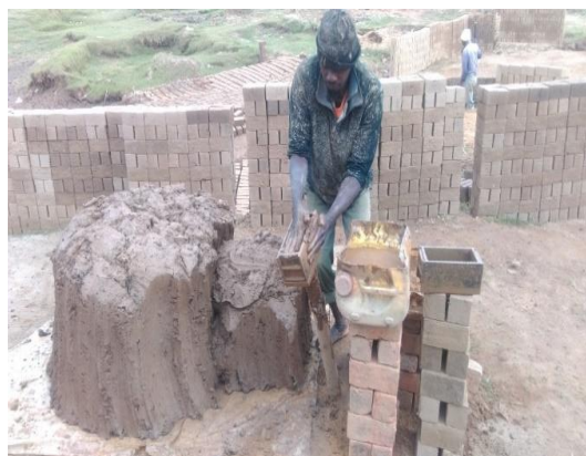
Photo 5 : Processus de moulage de l'argile crue
