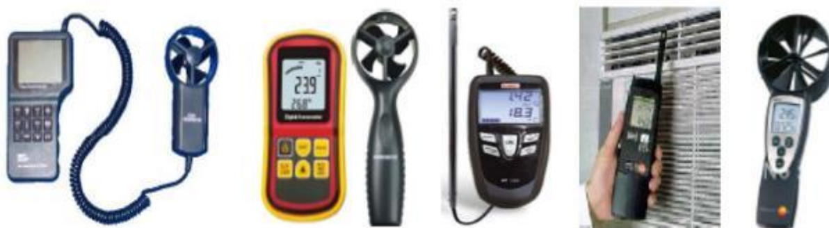
Photo 13 : Les appareils des mesures de la vitesse de l'air.
