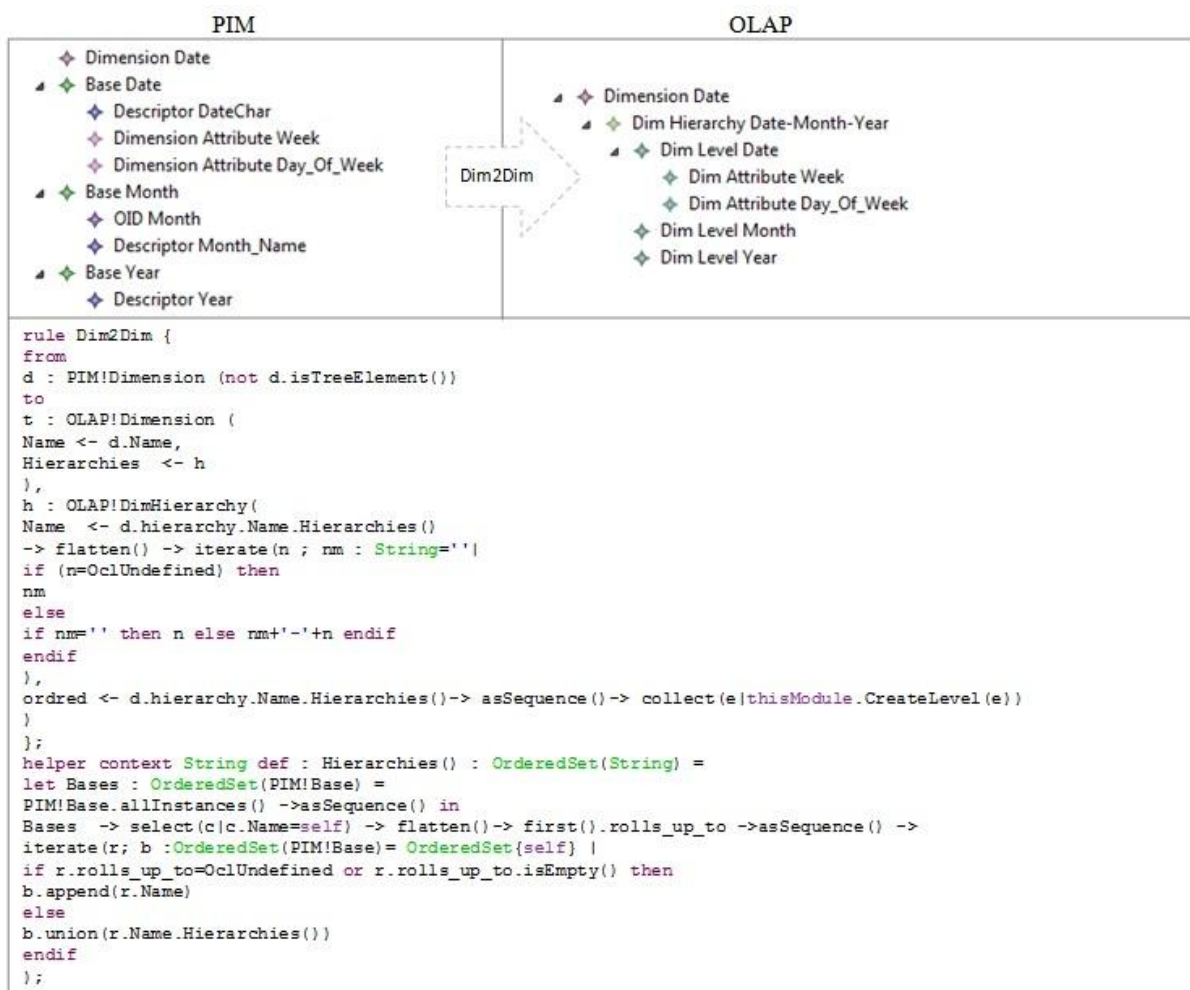
Figure 3.10 Règle de transformation d'une dimension du PIM vers une dimension dans le PSM
