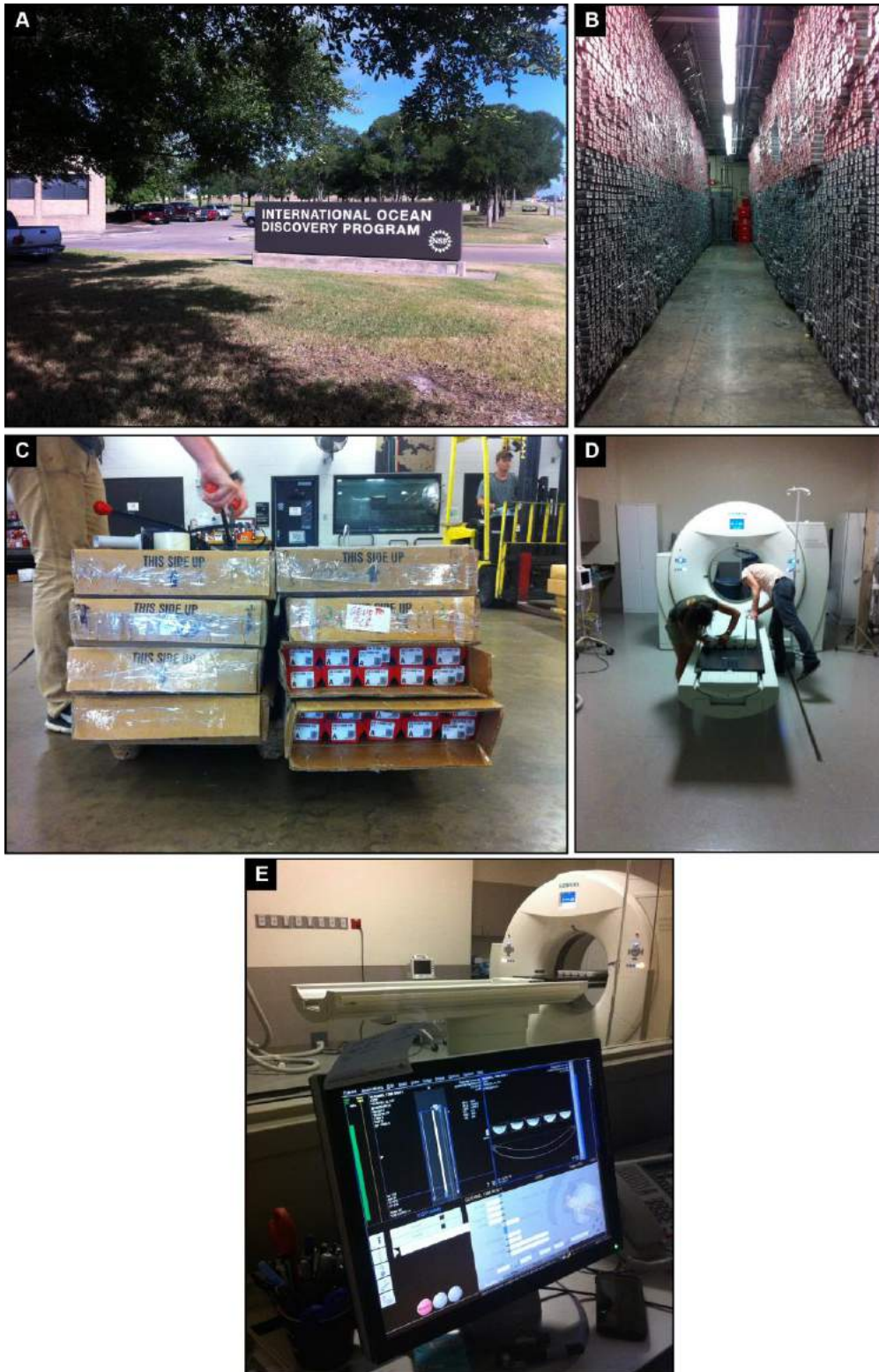
Figure II.24 : Acquisition des données de CAT-scan à l'Université A&T, Texas. (A) Centre IODP où, (2) les carottes sont stockées (Core Repository). (C) Préparation des carottes sélectionnées pour notre étude (1399-A et 1400-B) et transfert jusqu'à l'école vétérinaire. (D) où elles sont installées sur la table du scanner Siemens Somatom. (E) Les données de scan sont affichées en temps réel.
