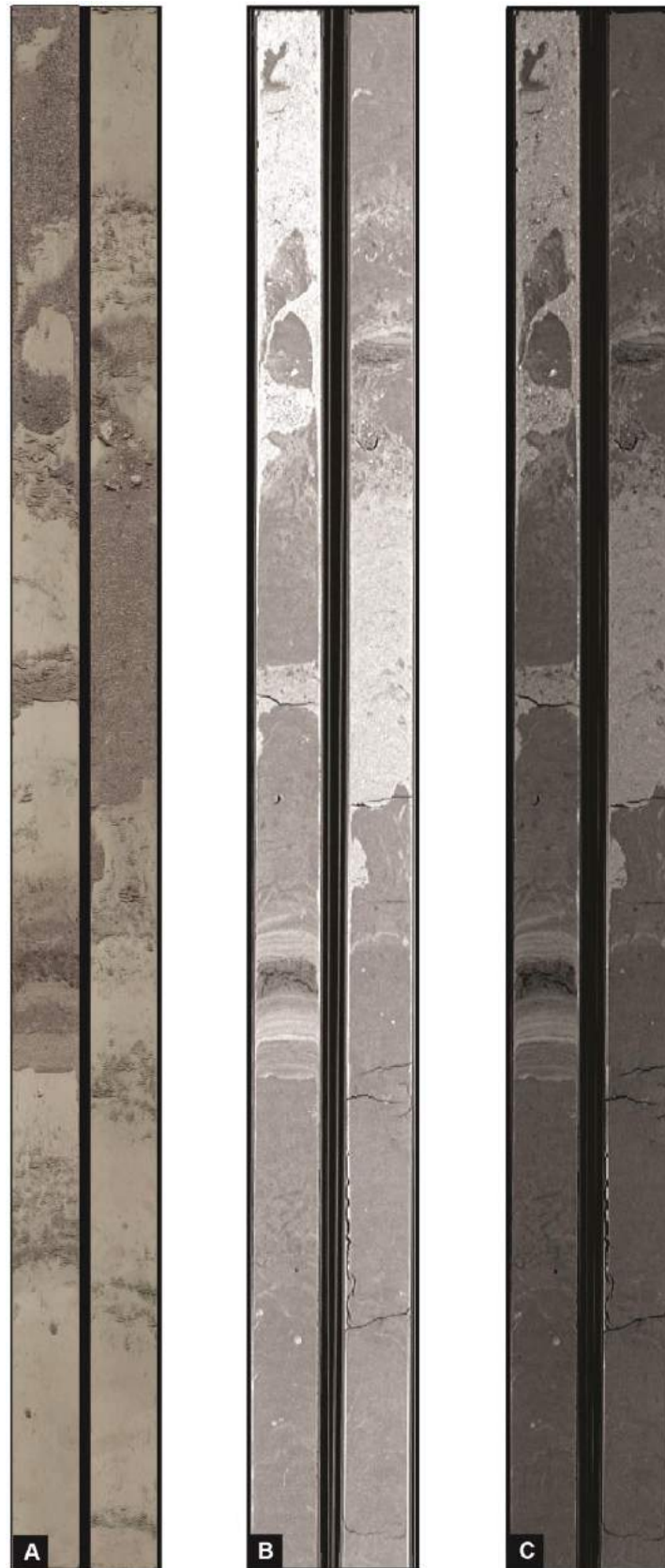
Figure II.26 : (A) Photographie de carotte (U1399-A-2H, section 3 et 4), (B) CAT-scan de la même carotte paramétré avec un faible contraste de densité et (C) paramétré avec un plus fort contraste via le logiciel Osirix.
