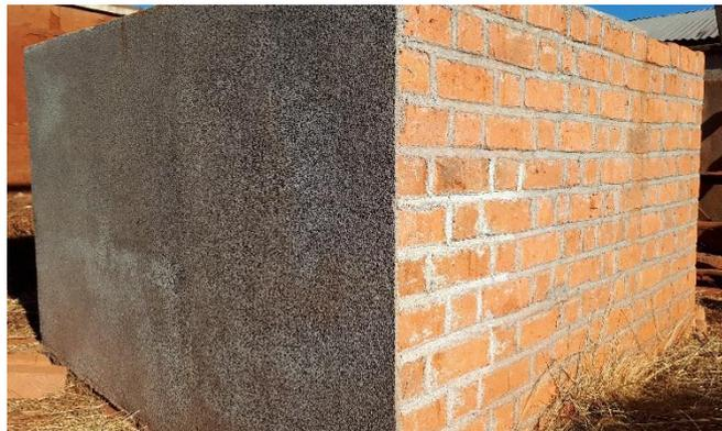
**Figure 27 : Cellule de mesure CBAC.**
