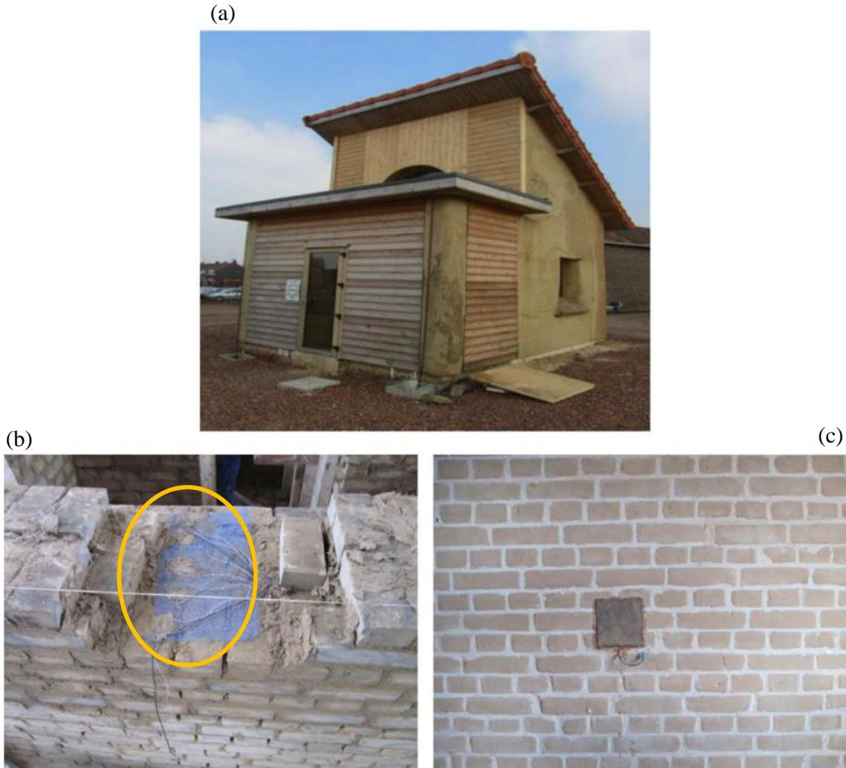
**Figure 20 : Exemple de caractérisation in situ par Fayçal [97] : (a) Bâtiment démonstratif ; (b) positionnement des thermocouples ; (c) positionnement du fluxmètre.**
