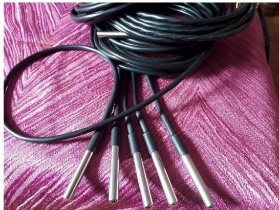
**Figure 30 : Sondes de température DS18B20.**
