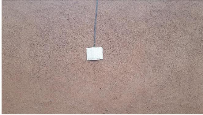
**Figure 39 : Positionnement des capteurs DS18B20 sur la CTCB.**
