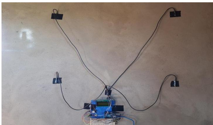
**Figure 35 : Emplacement lors de l'étalonnage des capteurs DS18B20 à l'intérieur.**
