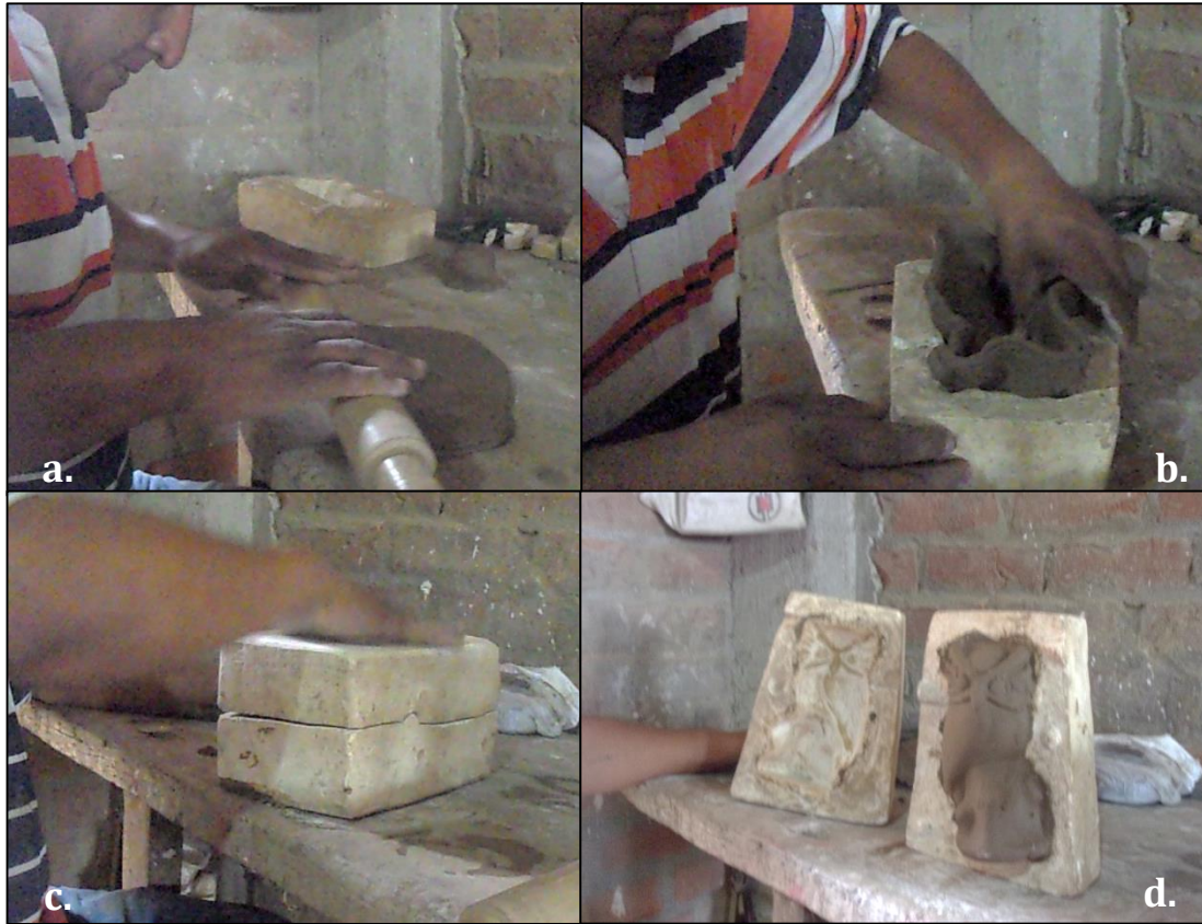
Figure 125 : La technique du moulage par estampage
