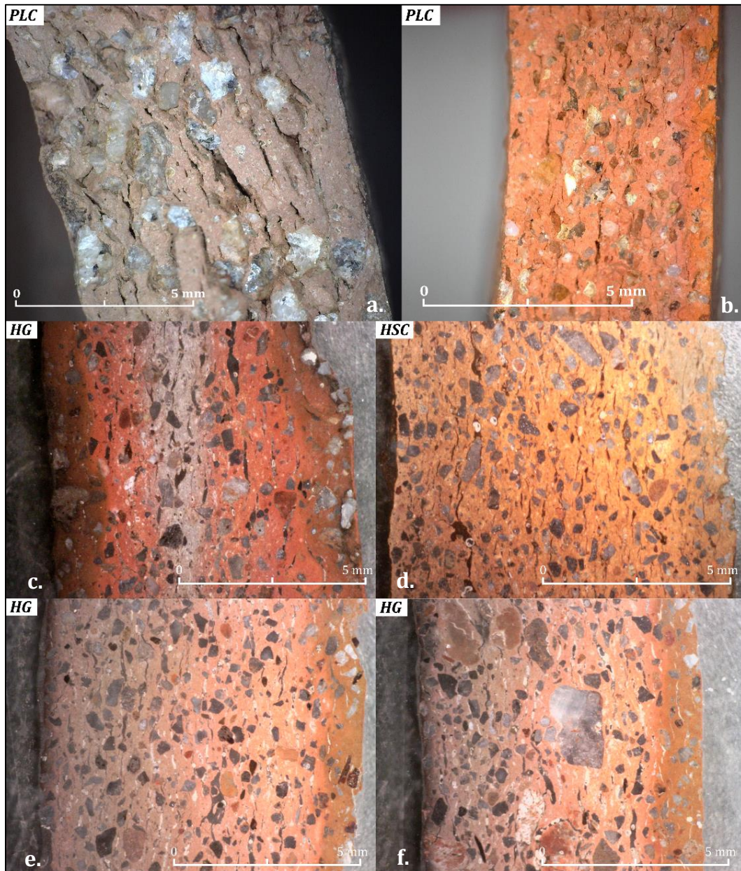
Figure 149 : Attributs diagnostiques du martelage visibles en section et sur lame mince
