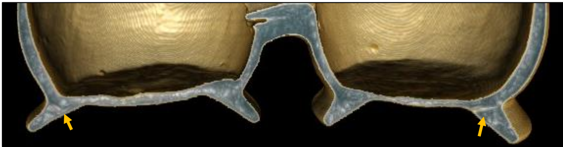
Figure 163 : Vue en coupe d'une bouteille à panse double (tomographie)
