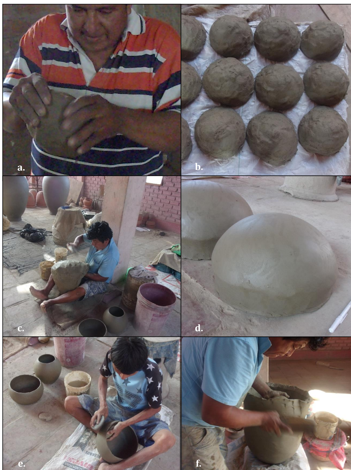
Figure 117 : Ébauchage et préformage de la panse
