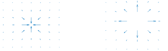
Figure H.2 – Puits et source de potentiel
