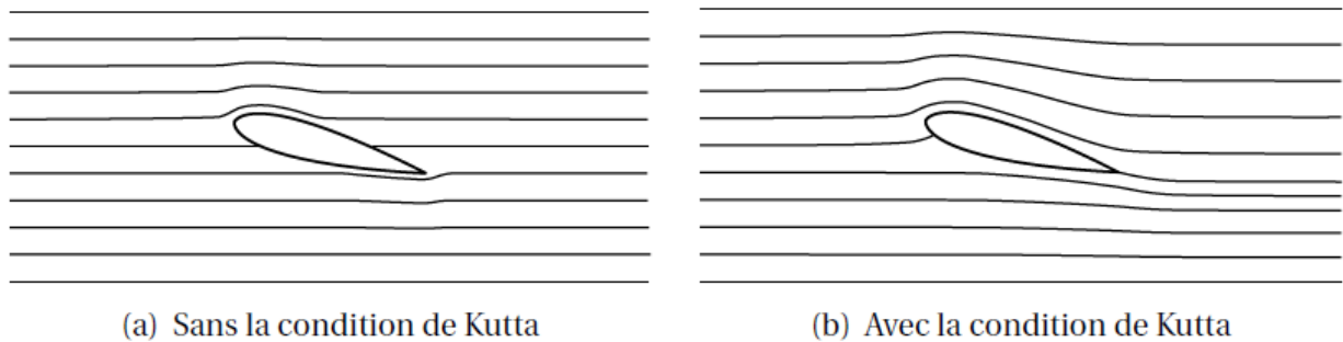
Figure 2.11 – Effet de la condition de Kutta sur l'écoulement de fluide parfait autour d'un aileron (Source : [Flo11])
