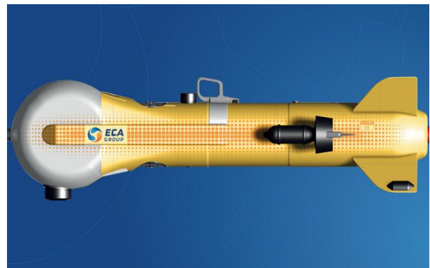
Figure 1.13 – Droite : Un véhicule sous-marin autonome détecte une mine. Gauche : Le véhicule K-STER C avec sa tête orientable pouvant être équipée d'une charge creuse. (Source : ECA Robotics)
