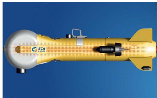
Figure 1.13 – Droite : Un véhicule sous-marins autonome détecte une mine. Gauche : Le véhicule K-STER C avec sa tête orientable pouvant être équipée d'une charge creuse. (Source : ECA Robotics)
