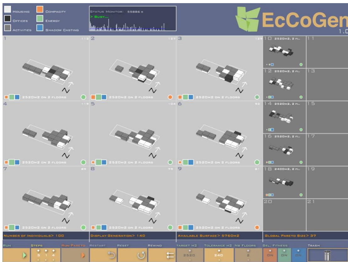
Figure 12. Interface de l'outil de conception évolutionnaire Éco-Conception Générative, projet ANR, équipe du laboratoire MAP CNRS-MCC
