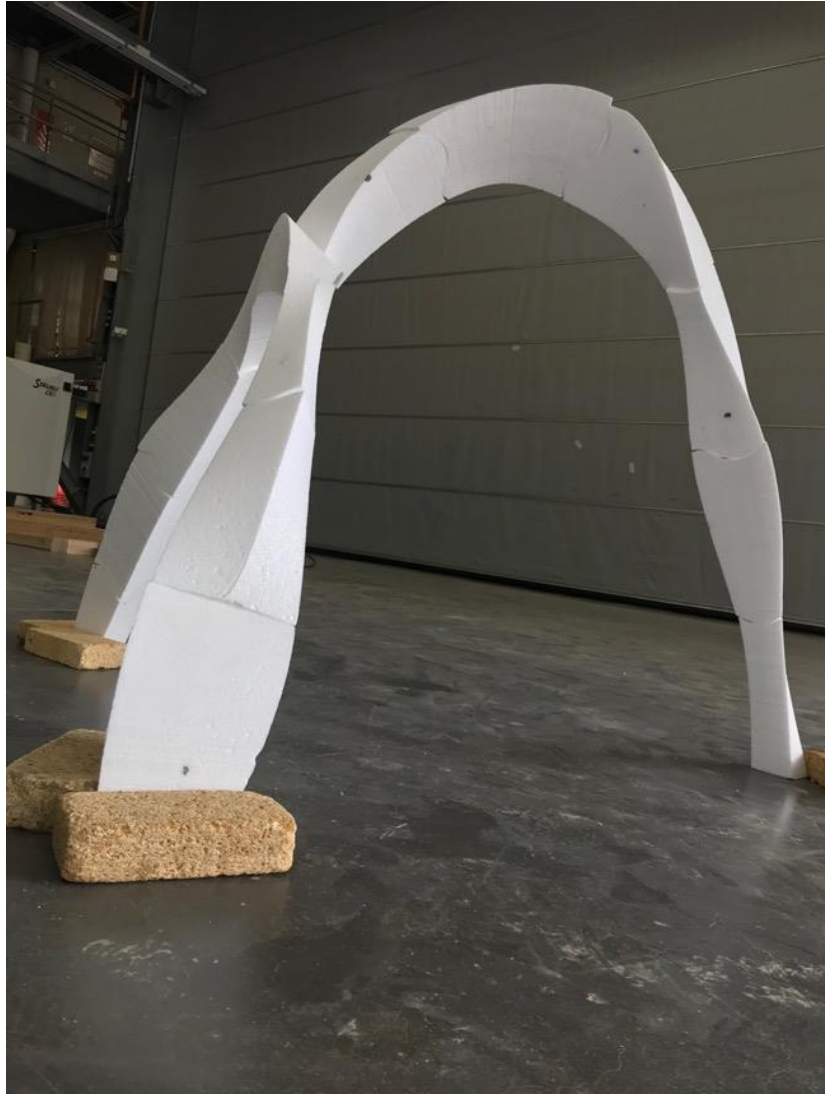
Figure 56. Arche funiculaire, construction par stéréotomie, Les Grands Ateliers, ENSAG, travaux de l'auteur, octobre 2019
