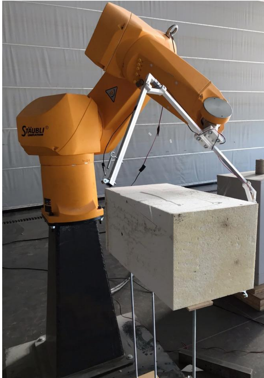
Figure 52. Découpe au fil chaud d'un voussoir dans un bloc de mousse, les Grands Ateliers, ENSAG, travaux de l'auteur, octobre 2019
