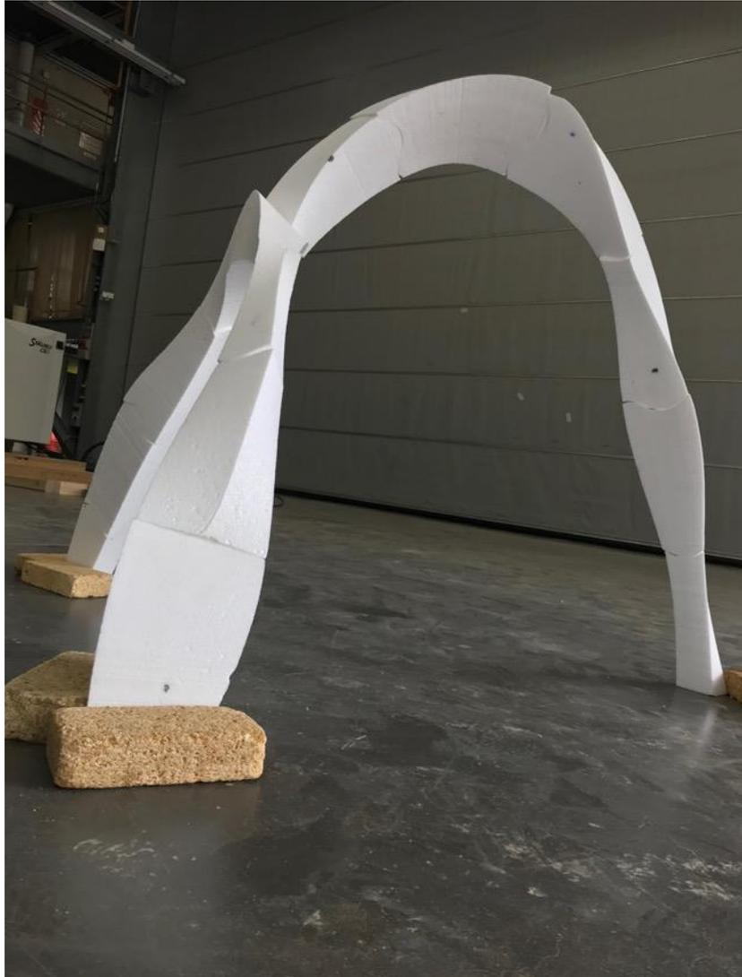
Figure 56. Arche funiculaire, construction par stéréotomie, Les Grands Ateliers, ENSAG, travaux de l'auteur, octobre 2019
