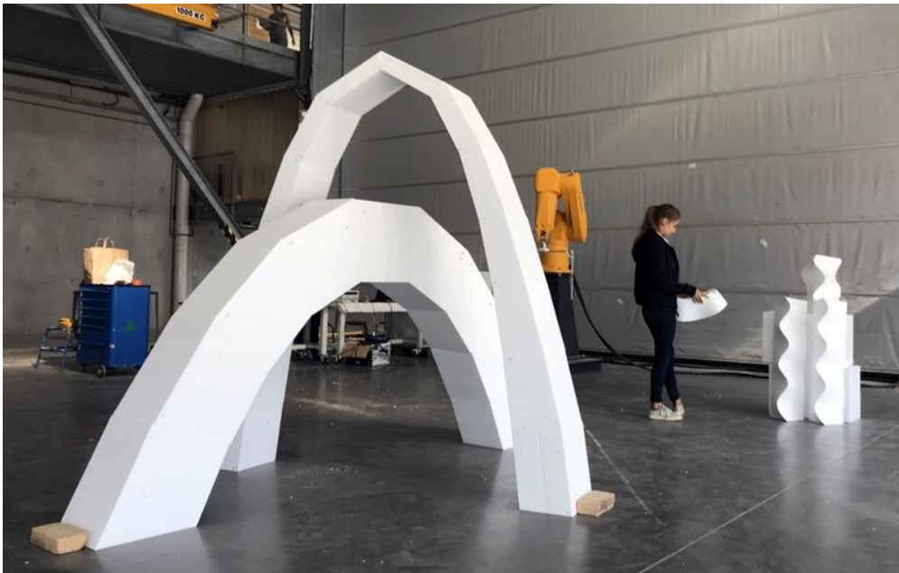
Figure 54. Réalisation de structures par stéréotomie, découpe robotisée de voussoirs, Les Grands Ateliers, ENSAG et ENSAL, travaux de l'auteur, janvier 2018
