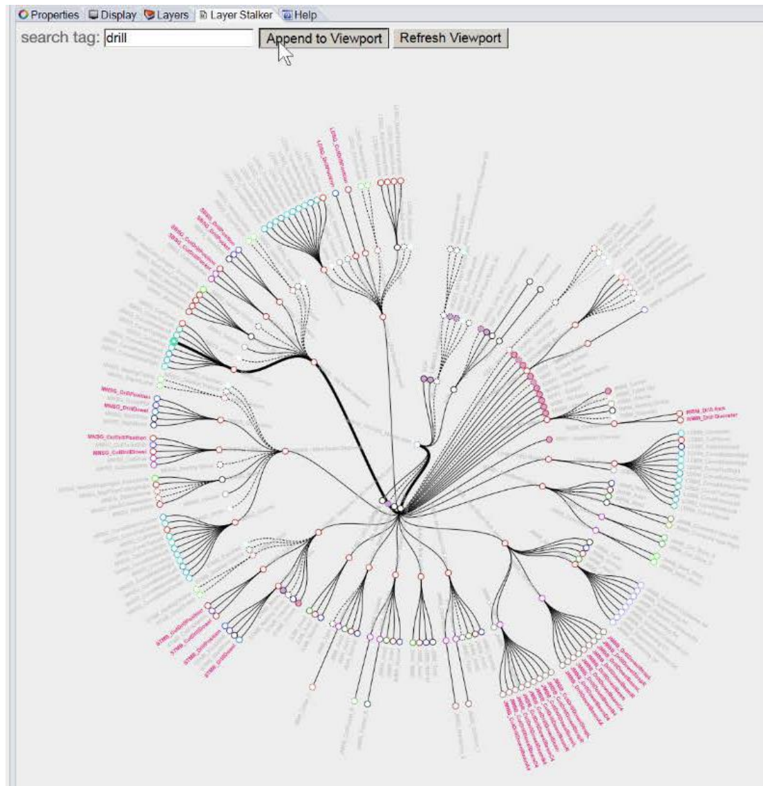
Figure 25. Visualisation de la structure d'un fichier Rhinoceros dans le cadre d'une modélisation d'un pavillon. Les branches du graphe représentent des calques et des groupes de calque. (Poinet et al. 2018)
