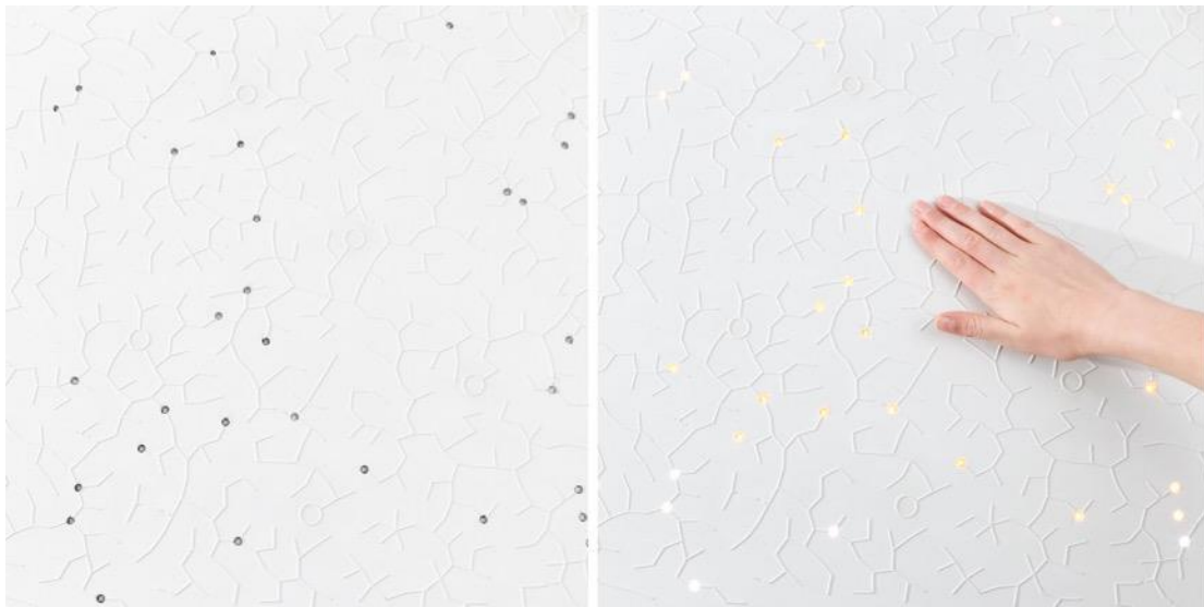
Figure 22. Projet Smart Concret, intégration d'une couche d'électronique dans une dalle de béton, des capteurs capacitifs activent un scénario lumière avec l'identification de la présence humaine, travaux de l'auteur, projet réalisé en collaboration avec le CEA, l'école d'architecture de Lyon, de Grenoble, 2012.
