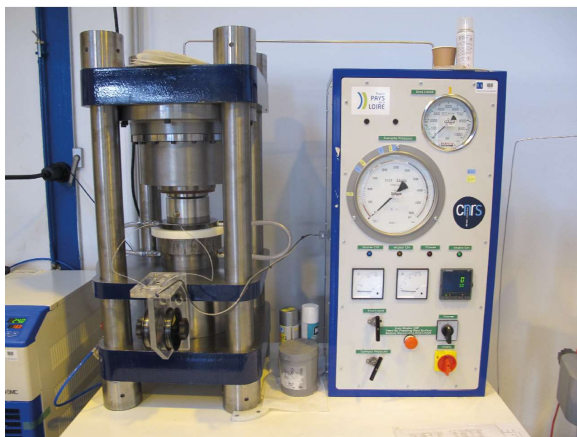
Figure 2.2 : Schéma du dispositif haute pression utilisé pour cette étude. Photo du dispositif et d'un assemblage.
