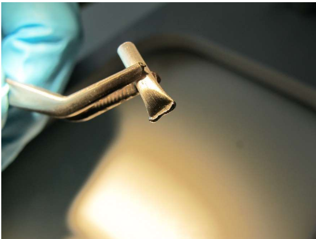
Figure 2.3 : Soudure à l'extrémité d'une capsule 2.9mm, utilisée pour des expériences en capsules doubles (deux capsules dans un assemblage \frac{3}{4} pouces) ou pour des expériences à 2 GPa (Assemblages \frac{1}{2} pouces).
