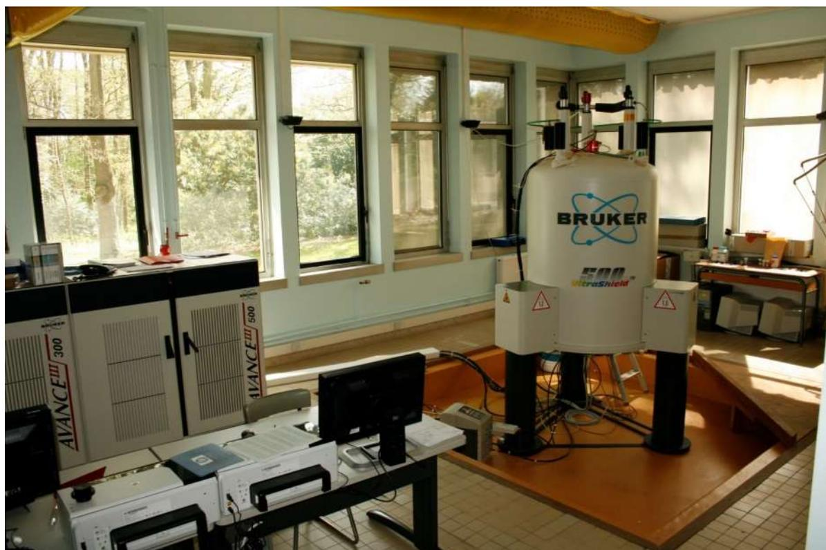
Figure 2.16 : Photographie du spectromètre utilisé dans le cadre de cette thèse, un Bruker avance III 500MHz.
