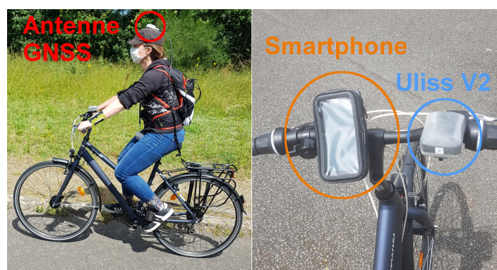
FIGURE 4.5 – Présentation des équipements d'acquisition et de référence du cycliste
