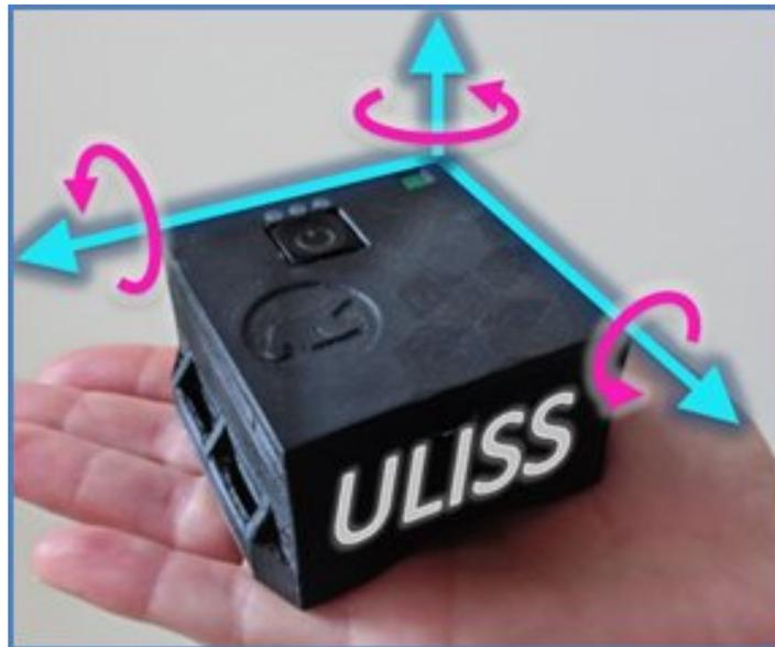
FIGURE 3.1 – Boîtier d'acquisition ULISS
