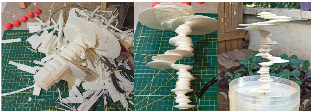
(a) Retrait des supports (b) Etape intermédiaire (c) Pièce finale
