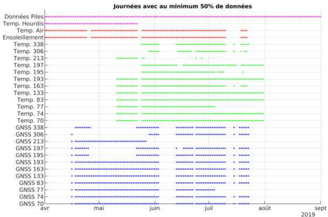
Figure III-7 Journées avec au moins 50% de données disponibles par capteurs sur le pont de Brotonne (d'avril 2019 à février 2019)
