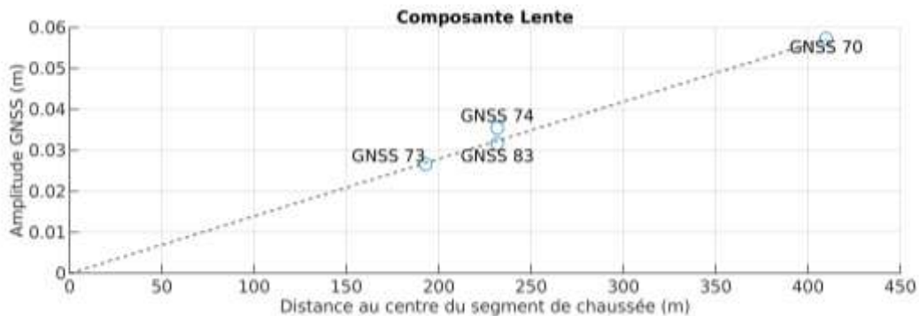
Figure III-33 Amplitude des séries GNSS (composante lente) comparées à leur distance au point fixe de leur chaussée
