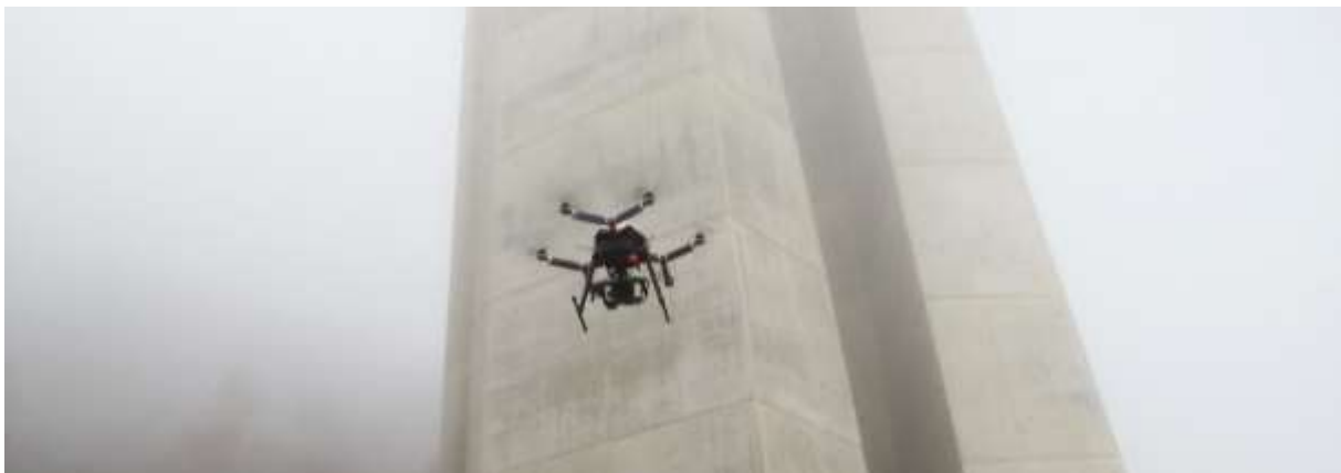
Figure I-9 Drone utilisé pour l'inspection d'un ouvrage
