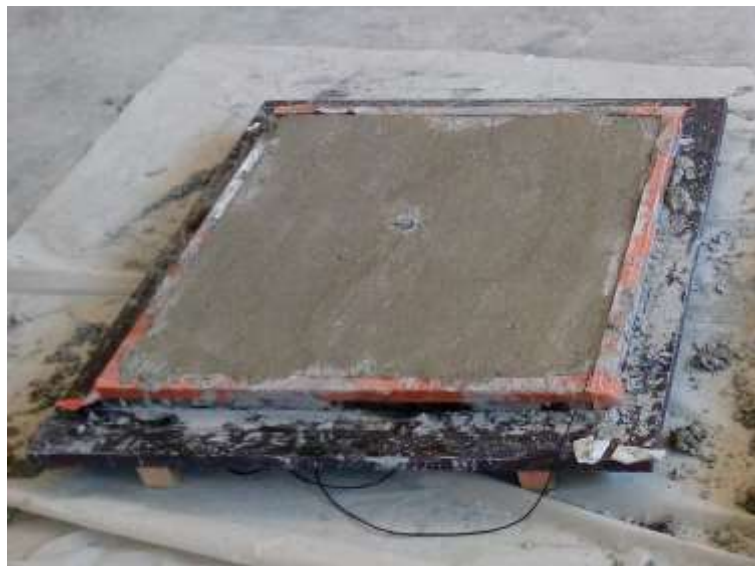
Figure II-19 Antenne incluse dans une dalle de béton
