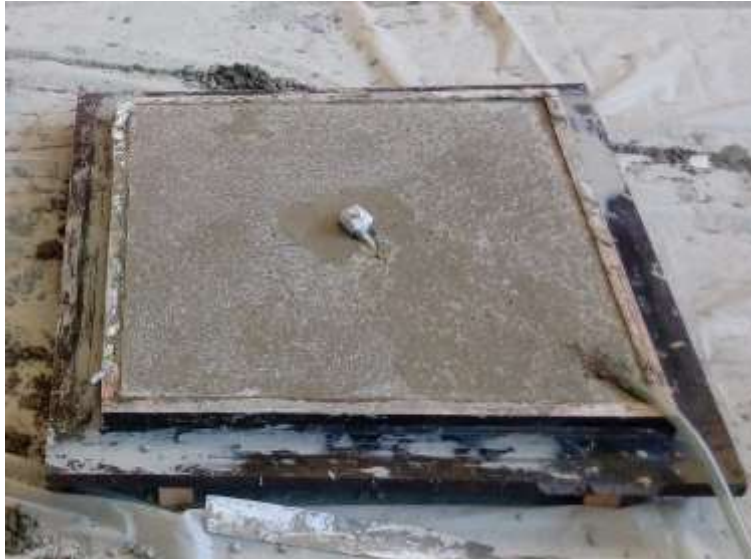
Figure II-20 Dalle avec emplacement pour insérer une antenne patch
