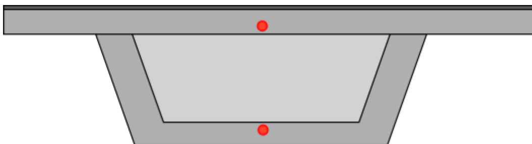
Figure III-5 Instrumentation des hourdis à proximité de la culée sud du pont de Brotonne
