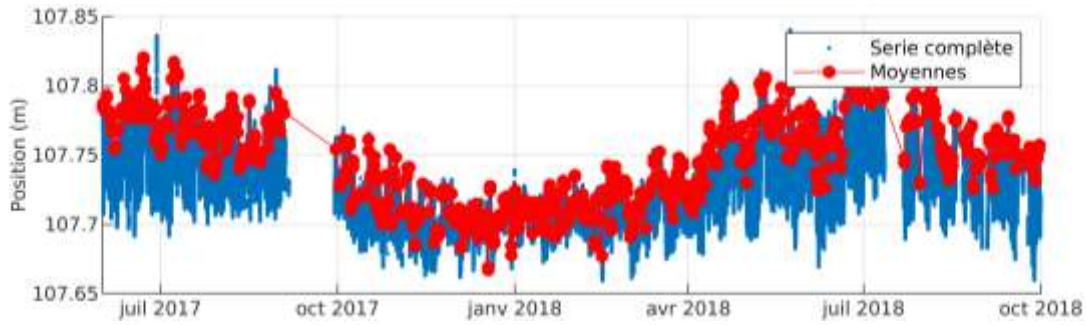
Figure III-44 Déplacements verticaux du capteur 80 et moyenne des mesures entre 4h et 6h du matin
