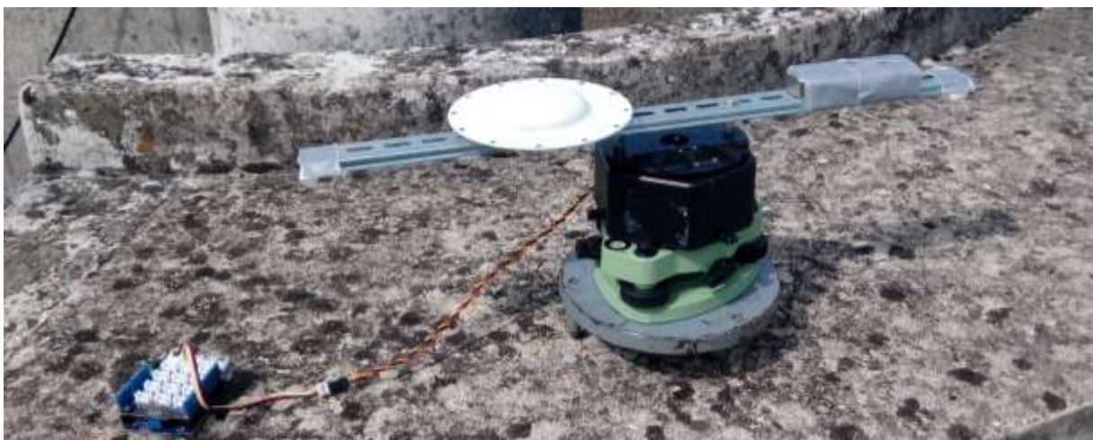
Figure II-31 Dispositif expérimental constitué d'un bras tournant mis en mouvement par un servomoteur
