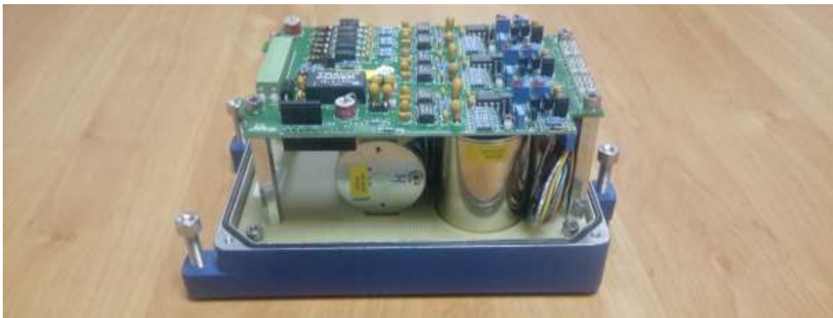
Figure I-2 Tandem d'accéléromètres pour la surveillance d'ouvrages
