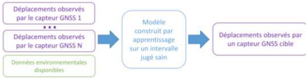
Figure IV-2 Fonctionnement d'un modèle de régression par apprentissage
