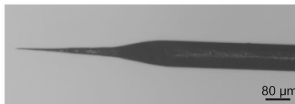
Figure 2.5 - Image prise par la camera du microscope optique de l'une des pointes fabriquées avant collage de la particule.
