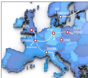
FIGURE 6.2 – Représentation des liens fibrés à travers l'Europe. Les traits pleins représentent les liens fibrés déjà existants, et les pointillés, ceux en projet. On ne s'intéresse qu'aux liens entre l'Allemagne, la France et le Royaume-uni
