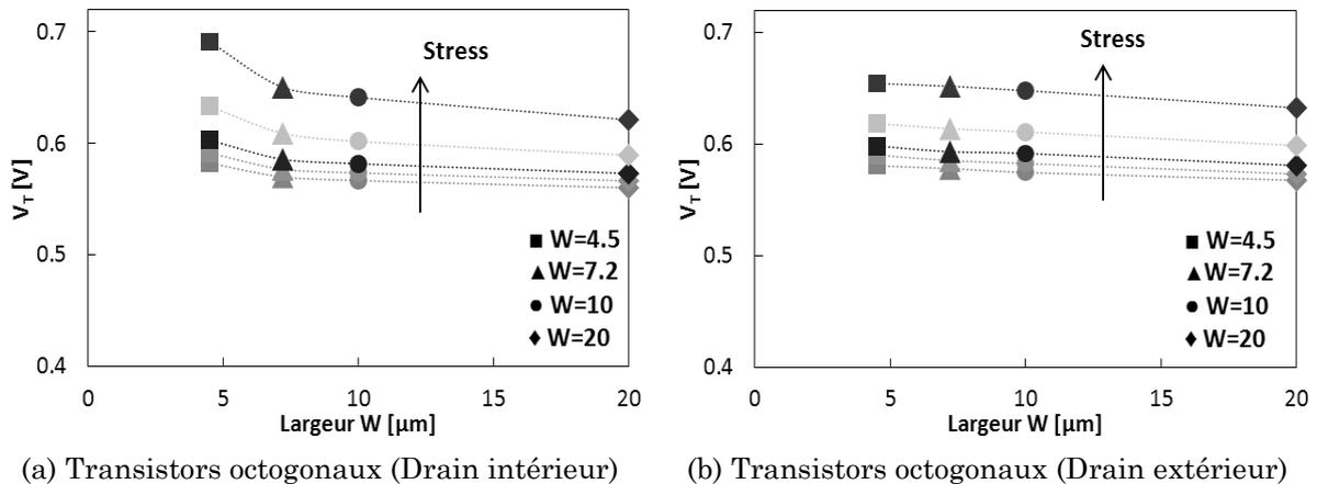
Fig. IV-27 : Evolution du  $V_T$  en fonction du stress
