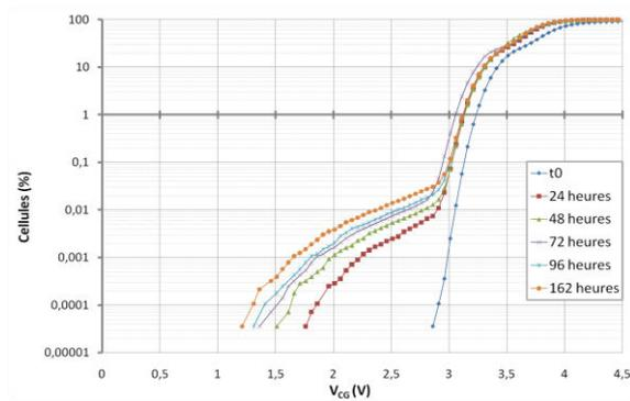
Fig. II-18 : Résultats des tests de cyclage/rétention après 250 000 cycles
