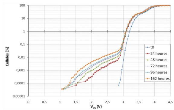
Fig. II-19 : Résultats des tests de cyclage/rétention après 300 000 cycles
