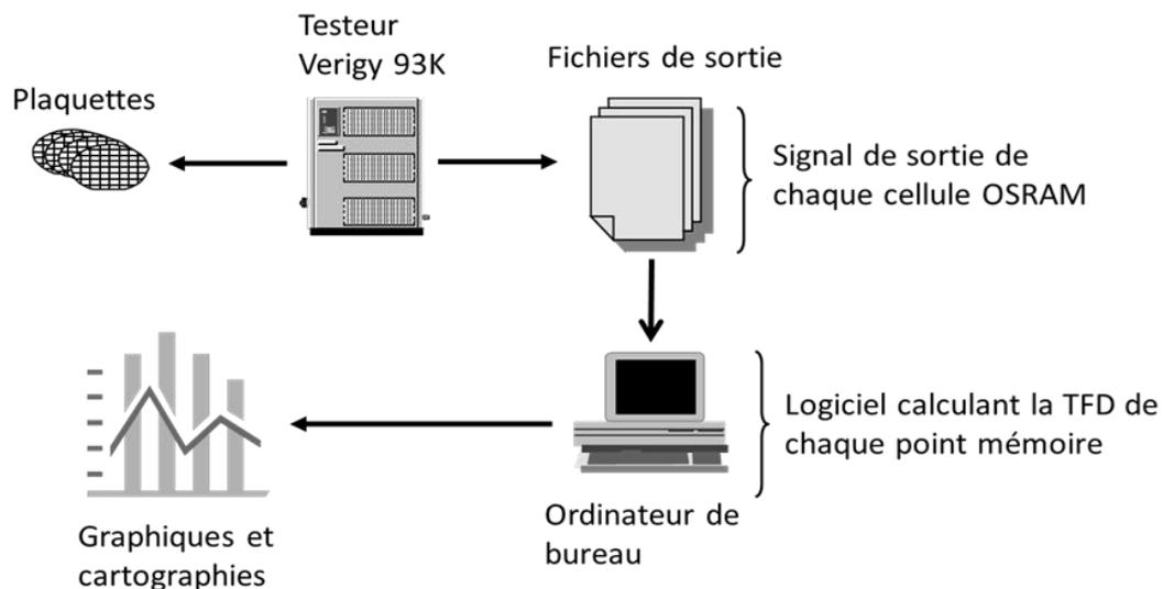
Fig. III-12 : Déroulement du test et analyses de résultats de test
