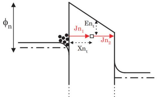
Fig. II-11 : Mécanismes tunnels assistés par un piège situé en  $X_t$  et ayant une énergie  $E_t$ . Le courant TAT est constitué d'un courant de capture  $J_{n1}$  et d'un courant d'émission du piège  $J_{n2}$
