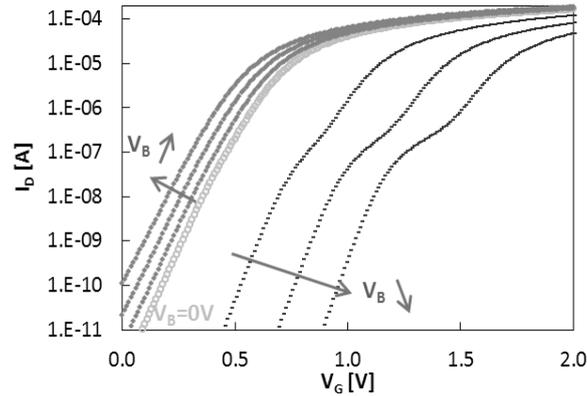
Fig. IV-17 : Caractéristiques  $I_D$ - $V_G$  de la structure de test étudiée ( $W=10\mu\text{m}/L=1.2\mu\text{m}$ ) en fonction de la polarisation de substrat ((-)  $V_B=-3\text{V}, -2\text{V}, -1\text{V}$ ), (( $\diamond$ )  $V_B=0\text{V}$ ), (( $\blacklozenge$ )  $V_B=0.1\text{V}, 0.2\text{V}, 0.3\text{V}$ )
