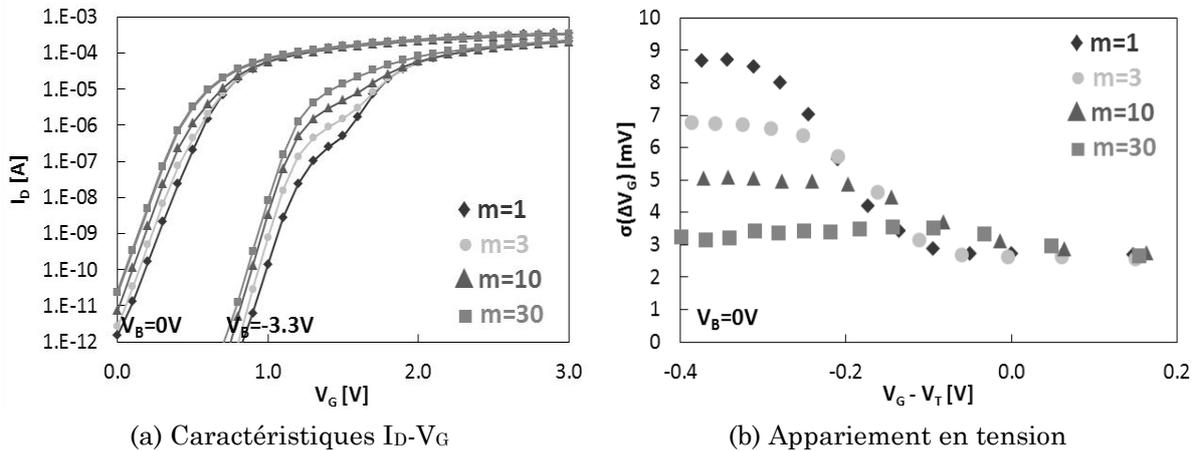
Fig. IV-20 : Comparaisons des caractéristiques  $I_D-V_G$  et de l'appariement en tension en fonction du nombre de doigt des transistors ( $W=12\mu\text{m}/L=1\mu\text{m}$ )
