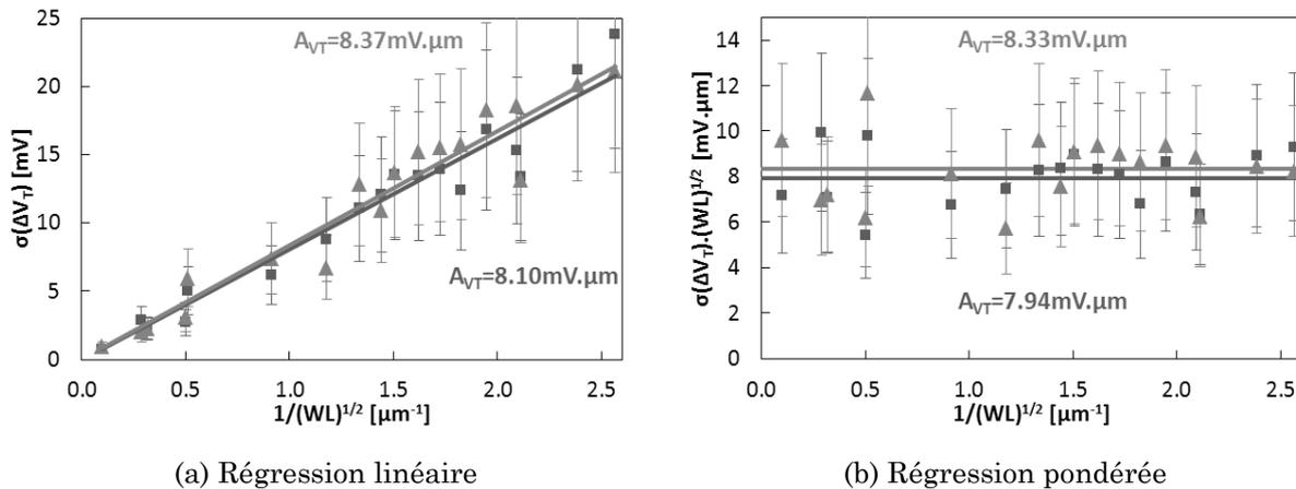
Fig. IV-7 : Comparaison de l'extraction du paramètre  $A_{VT}$  par la méthode du maximum de transconductance (carré bleu) ou à courant constant (triangle vert). Barres d'erreur données dans un intervalle de confiance de 99.7%
