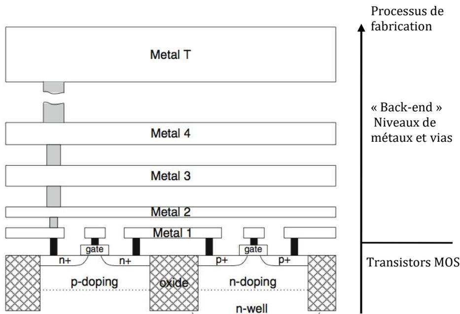
Fig. I-19 : Vue en coupe schématique d'un circuit CMOS comprenant « T » niveaux de métaux
