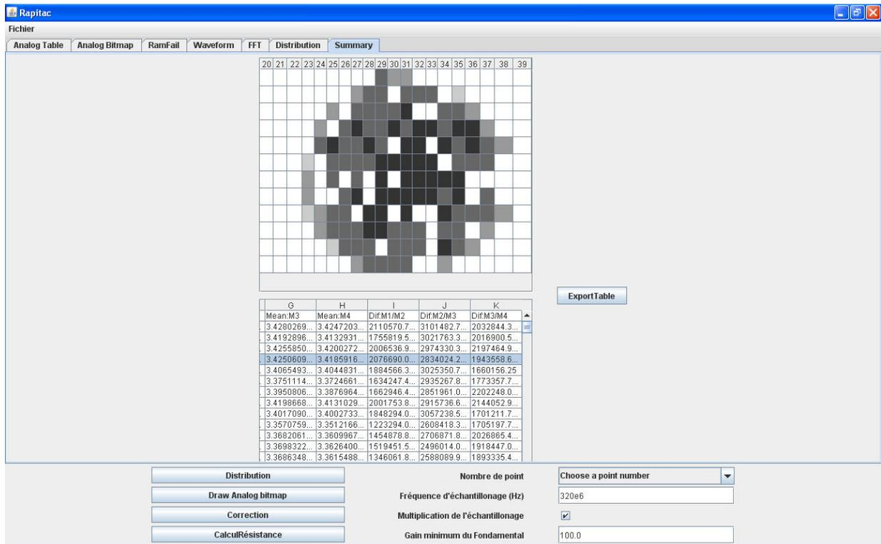
Fig. III-15 : Représentation graphique des fréquences d'oscillation le long de la plaquette (a) et table résumant les différents comportements de chaque puce (b)
