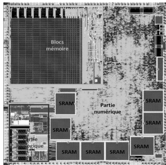
Fig. I-4 : Vue Layout<sup>42</sup> des principaux blocs composant un microcontrôleur
