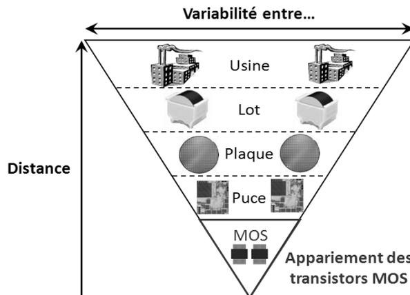
Fig. IV-1 : Variabilité des dispositifs suivant la distance
