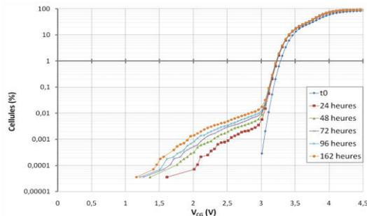
Fig. II-15 : Résultats des tests de cyclage/rétention après 100 000 cycles
