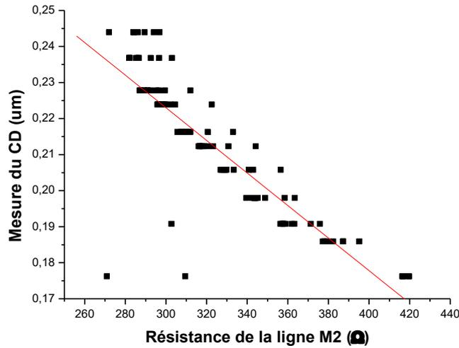
Fig. III-18 : Corrélation entre les mesures effectuées après la photolithographie de la ligne 2 et la résistance de la ligne 2 mesurée au test paramétrique
