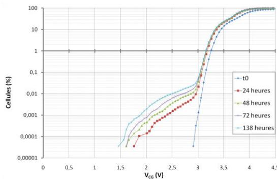
Fig. II-17 : Résultats des tests de cyclage/rétention après 200 000 cycles
