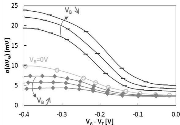
Fig. IV-18 : Appariement en tension de la structure de test étudiée ( $W=10\mu\text{m}/L=1.2\mu\text{m}$ ) en fonction de la polarisation de substrat ((-)  $V_B=-3\text{V}, -2\text{V}, -1\text{V}$ ), (( $\circ$ )  $V_B=0\text{V}$ ), (( $\blacklozenge$ )  $V_B=0.1\text{V}, 0.2\text{V}, 0.3\text{V}$ )
