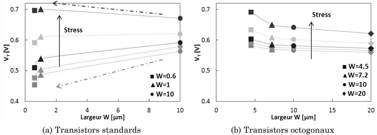
Fig. IV-25 : Evolution du  $V_T$  en fonction du stress
