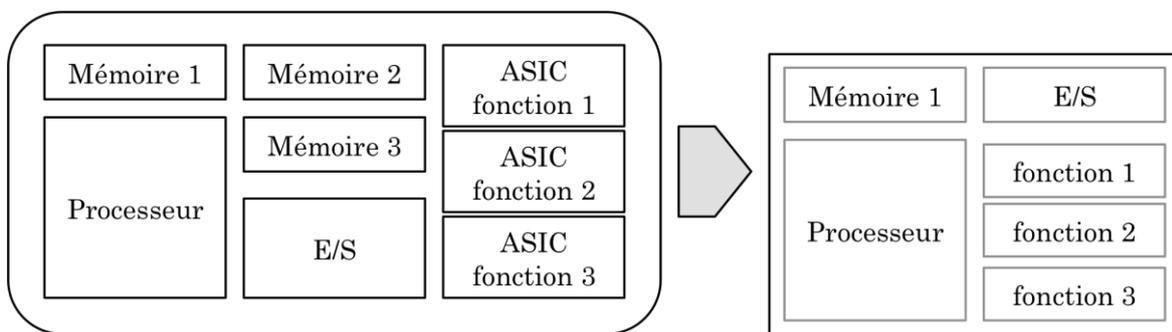
Fig. I-2 : Du circuit intégré vers le SoC
