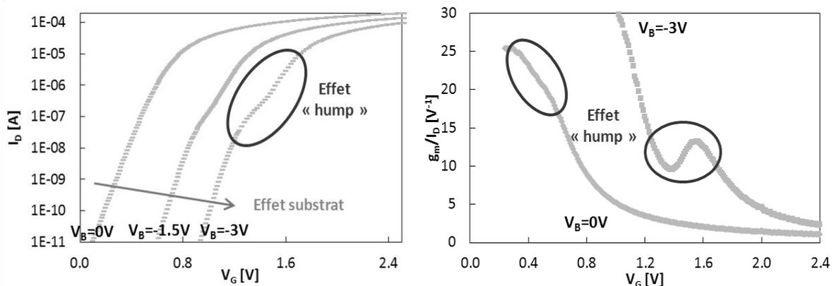
Fig. IV-11 : (a) Caractéristiques  $I_D$ - $V_G$  de la structure de test étudiée ( $W=10\mu\text{m}/L=1.2\mu\text{m}$ ) en fonction de la polarisation de substrat ( $V_B=0\text{V}$ ,  $-1.5\text{V}$  et  $-3\text{V}$ ) (b) Rapport  $g_m/I_D$  de la structure de test étudiée ( $W=10\mu\text{m}/L=1.2\mu\text{m}$ ) avec ( $V_B=-3\text{V}$ ) et sans effet substrat ( $V_B=0\text{V}$ )
