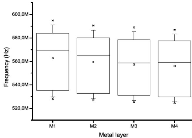
Fig. III-16 : « Box plot » des fréquences d'oscillation d'une plaquette de silicium par type d'OSRAM
