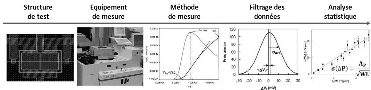
Fig. IV-3 : Méthodologie de mesure des fluctuations locales
