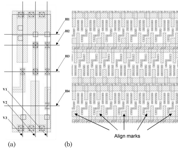
Fig. III-6 : Plan de positionnement des vias (a) et marques d'alignement (b) pour les analyses physiques
