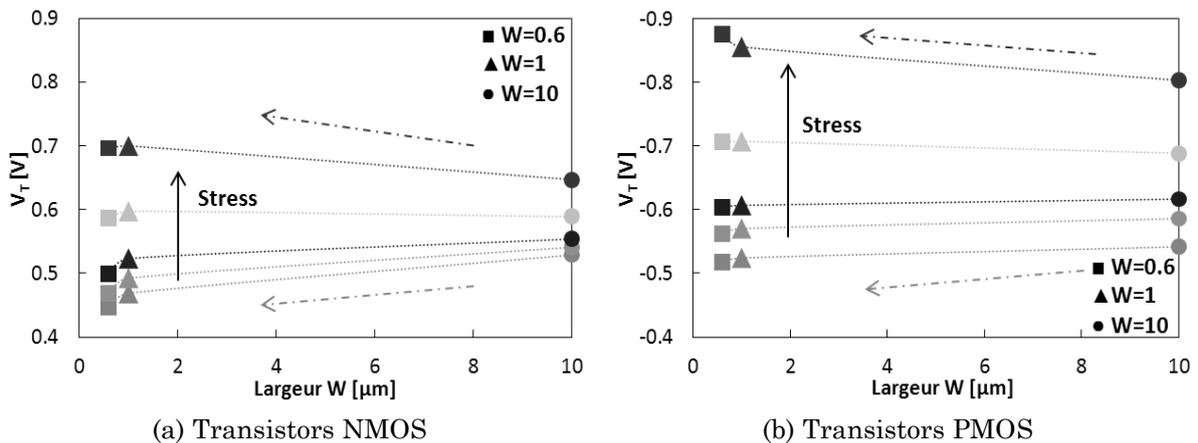
Fig. IV-21 : Evolution du  $V_T$  en fonction du stress
