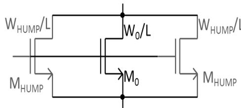
Fig. IV-12 : Macro-modèle pour modéliser l'effet « hump »
