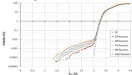
Fig. II-14 : Résultats des tests de cyclage/rétention après 50 000 cycles
