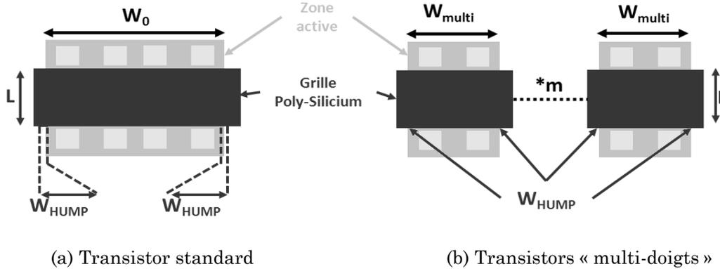
Fig. IV-19 : Vue « layout » simplifiée d'un transistor en « multi-doigts »
