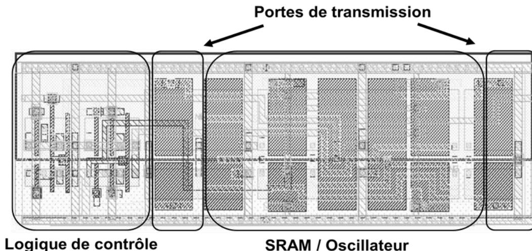
Fig. III-9 : Layout customisé de la cellule OSRAM ( $94\mu\text{m}^2$ )
