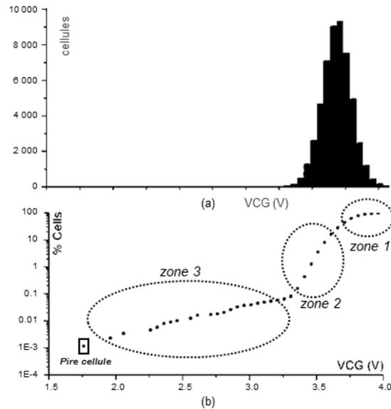
Fig. I-18 : Distribution des tensions de seuil
