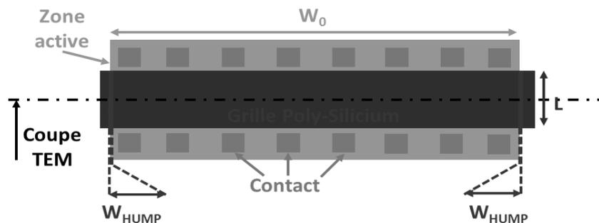
Fig. IV-9 : Vue « layout » simplifiée du transistor étudié ( $W=10\mu\text{m}/L=1.2\mu\text{m}$ )
