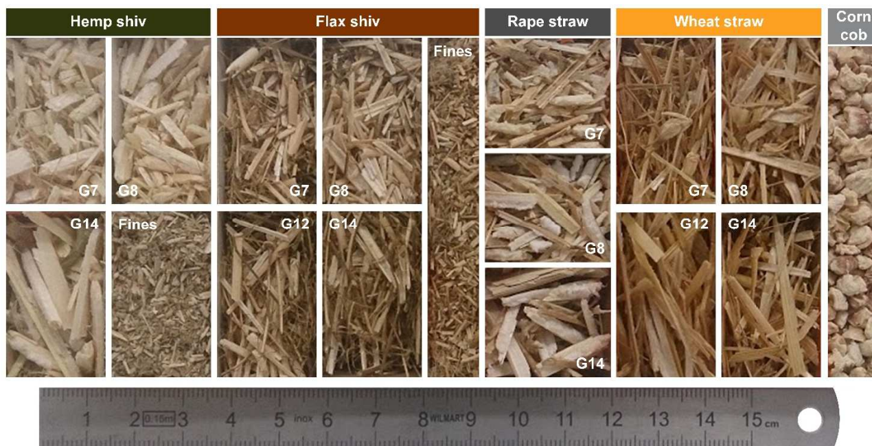
Figure 6 : Granulats bio-sourcés fournis par la CAVAC dans le cadre du projet européen ISOBIO
