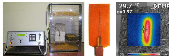
Figure 44 : Mesure de la conductivité : CT-mètre et armoire sèche, sonde fil L=5 cm, visualisation infra-rouge après essais
