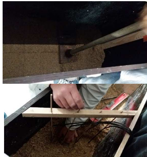
Figure 66 : Mise en œuvre et instrumentation de la paroi en fines stabilisées - chanvre
