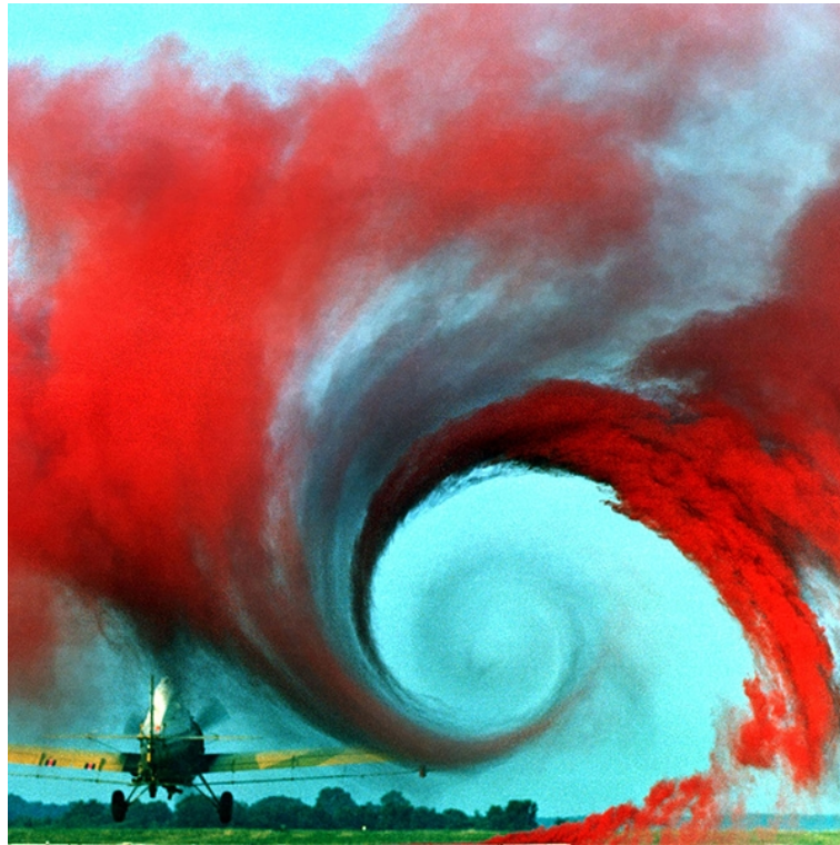
FIGURE 1.7: Fumée d'un avion agricole montrant la turbulence de sillage (NASA Langley Research Center). - ©Wikimedia Commons
