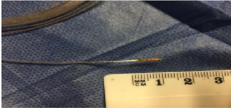
FIGURE 3.26 – Capteur de position électromagnétique TrackStar
