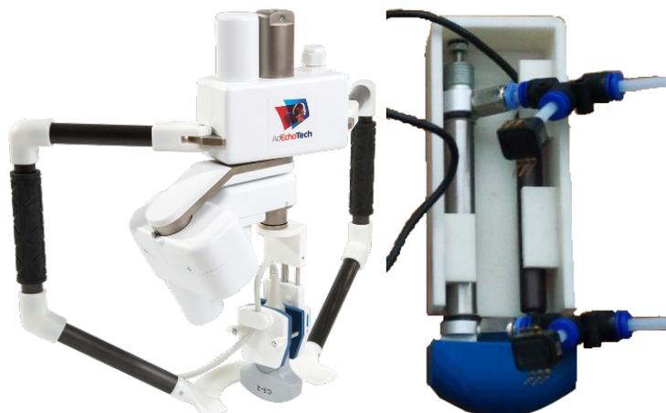
FIGURE 3.22 – A gauche, le robot Melody de la société Adechotech, à droite, notre sonde maître haptique pneumatique
