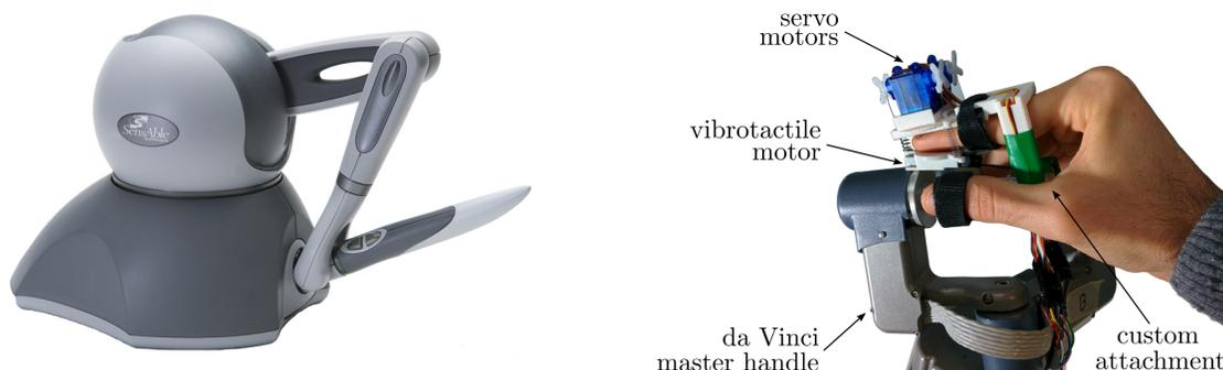
FIGURE 1.1 – Dispositifs haptiques à 3 degrés de liberté : le Phantom Omni de SensAble<sup>®</sup> (à gauche) et l'interface tactile BioTac<sup>®</sup> (à droite).
