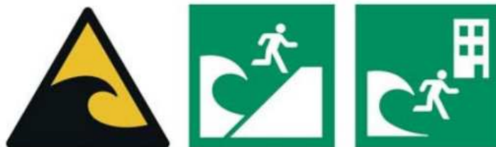
Figure 90 : Symboles approuvés selon les normes ISO pour l'affichage de l'aléa tsunami et les évacuations. De gauche à droite ISO 20712-1 :2008 – WSW014 ; ISO 20712-1 :2008 – WSE002 et ISO 20712-1 :2008 – WSE003, source : Kong (2009)
