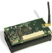
Figure 1 : Aspect d'un capteur Micaz
