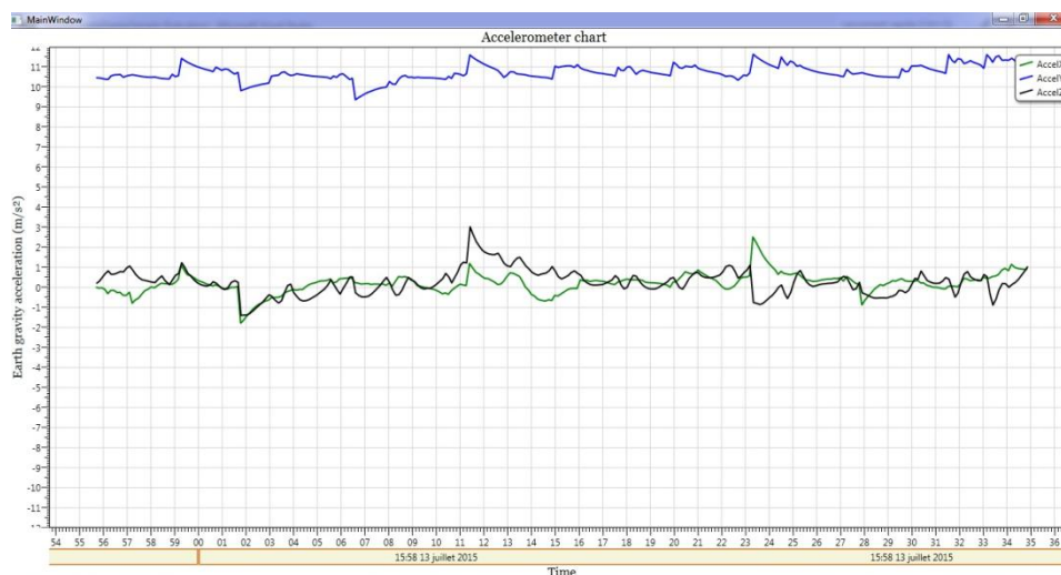
Figure 3.18 Détection d'un pas à travers l'accélération liée à la gravité
