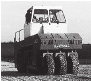
Figure I-2 9 - Compacteur à pneu
