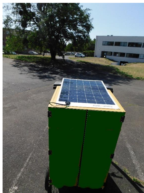
Figure B-10 : Photo du panneau solaire installé sur le toit du vélo (170 Wc).
