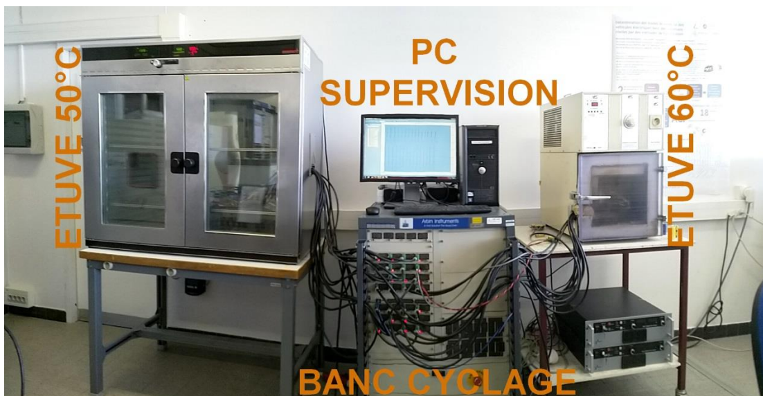
Figure 2-23 : Dispositif de test avec deux enceintes pour les essais de vieillissement.
