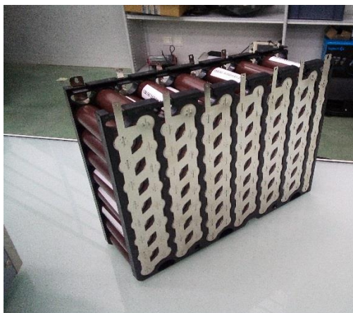
Figure B-17 : Assemblage d'une batterie maison à base de 104 cellules NMC LG HG2.
