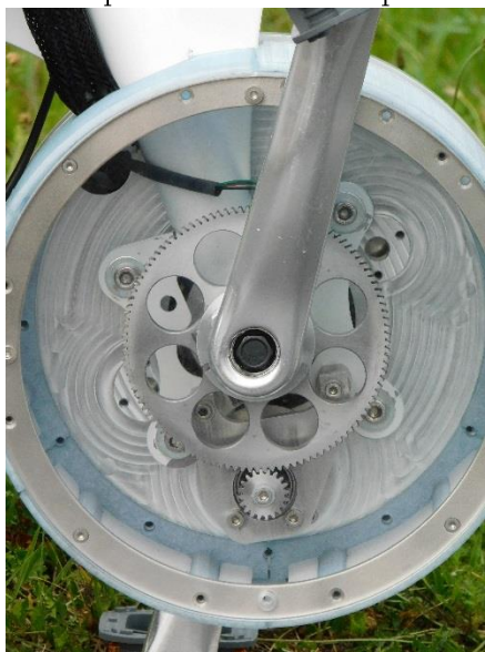
Figure B-5 : Illustration de la génératrice intégrée au pédalier.
