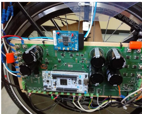
Figure B-1 : Carte d'électronique de contrôle. On distingue le pont de diode à droite, un banc de condensateurs pour le redressement DC associé, une carte Nucléo pour le contrôle du véhicule ainsi que de la connectique pour les nombreuses entrées sorties de contrôle et de puissance du système.
