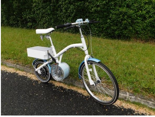
Figure B-6 : Photo du vélo complet, on distingue le bloc générateur, la machine dans la roue ainsi que la boîte/porte-bagages contenant les supercondensateurs.
