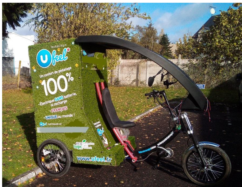
Figure B-8 : Photo du triporteur décoré vu sur le côté. Mise en évidence de la surface frontale élevée, des roues larges, et de la non-ergonomie du cycle pouvant expliquer en partie la consommation élevée du véhicule.
