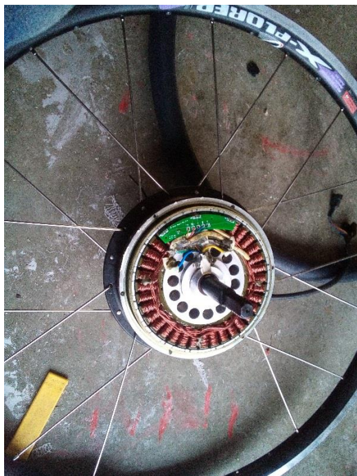
Figure B-15 : Changement de capteur à effet hall et rayonnage.
