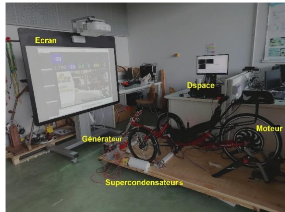
Figure 4-22 : présentation de la plateforme de test, vue globale avec la machine, les supercondensateurs et l'écran pour faire défiler le parcours.
