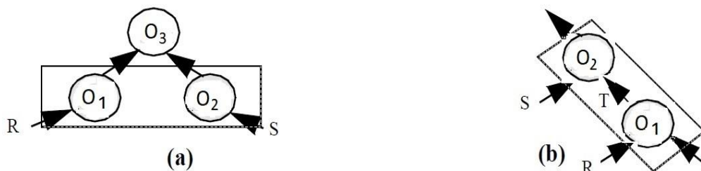
FIGURE 4.6 - Parallélisme inter-opérateurs : (a) indépendant (b) et pipeline.
