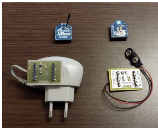
FIGURE 2.7 – Exemple de nœuds ZigBee, sur secteur (à gauche) et sur batterie (à droite)
