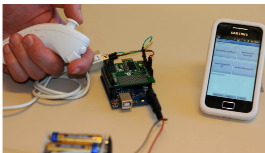
FIGURE 2.3 – Dispositif mobile utilisé par le visiteur en complément de son téléphone, développé autour d'une manette de Wii (nunchuk), d'une carte arduino (microcontrôleur) et d'un étage de communication bluetooth.
