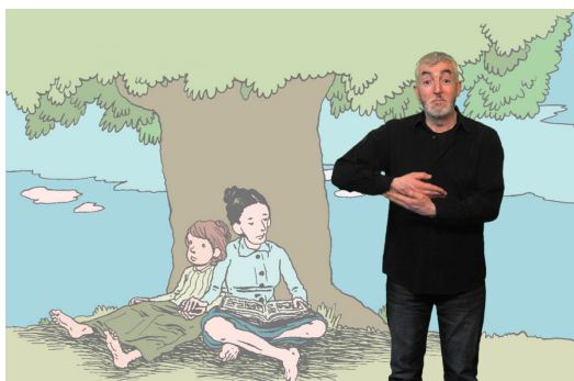
FIGURE 4.16 – Mise en emphase de la partie signée par un réglage de l’alpha de l’arrière plan.
