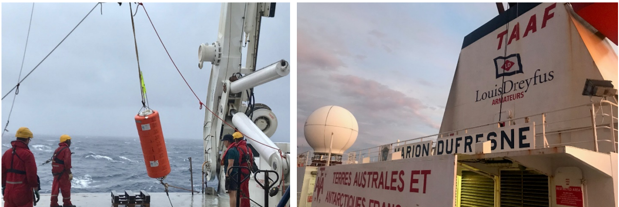
Figure 14: Gauche : récupération d'un hydrophone avec son système d'acquisition protégé dans une bouée cylindrique. L'ensemble est attaché à un mouillage pour que l'instrument soit immergé dans le canal SOFAR. Droite: le Marion Dufresne permet la maintenance du réseau OHA-SISBIO avec ses sites placés sur routes des Terres Australes et Antarctiques Françaises.
