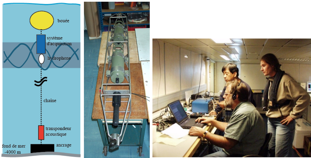
Figure 13: : Gauche: schéma simplifié d'un hydrophone autonome déployé dans le canal SOFAR (dessin modifié de Fox et al., 2001). Centre: Prototype que j'ai développé avec L. Béquery dans le laboratoire de St Maur de l'IPGP. Droite: mission océanographique SIRENA (2002) avec les concepteurs de la méthode: Chris Fox et Haru Matsumoto.
