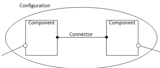
FIGURE 3.1: Exemple de description d'architecture en ADL
