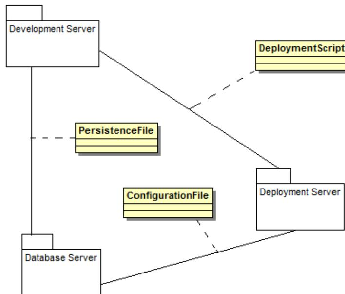
FIGURE 2.7: Inter-connectivité des différents serveurs d'une application J2EE
