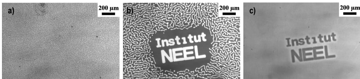
Figure A-5 – Exemple de structures magnétiques réalisées par TMP. a – Image "brute" de la surface obtenue par microscopie optique conventionnelle (en utilisant des fluences de laser typiquement inférieures à  $250 \text{ mJ/cm}^2$ , la surface Ta/NdFeB/Ta n'est optiquement pas "dégradée"). b – Image obtenue à l'aide d'un MOIF-Uniaxial (image binaire) révélant le motif TMP "Institut Néel". c – Image acquise grâce à un MOIF-Planaire (image codée sur 256 niveaux de gris).
