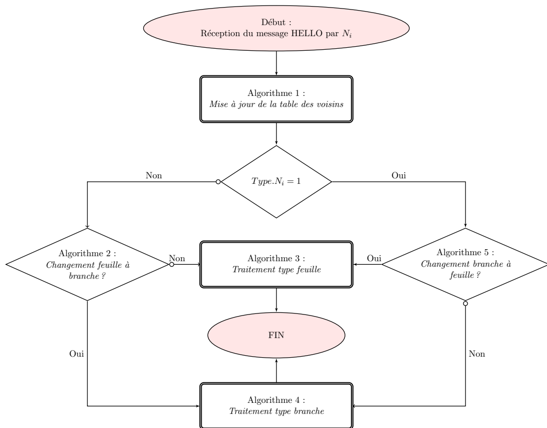
FIGURE 2.6 – Procédure utilisée lors de la réception d'un message HELLO [1]
